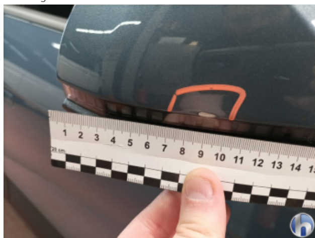
1. Außenspiegel Gehäuse - Rechts Beschädigt - Smart Repair
