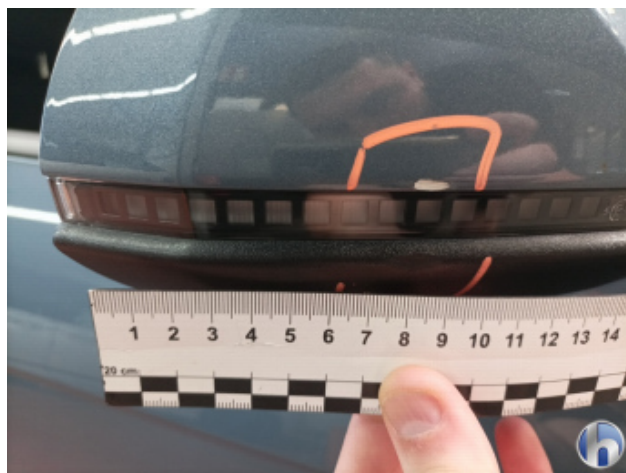
1. Außenspiegel Gehäuse - Rechts Beschädigt - Smart Repair
