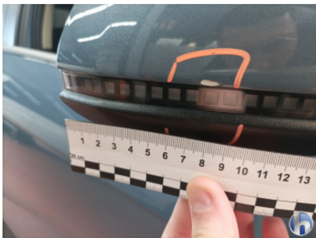
1. Außenspiegel Gehäuse - Rechts Beschädigt - Smart Repair
