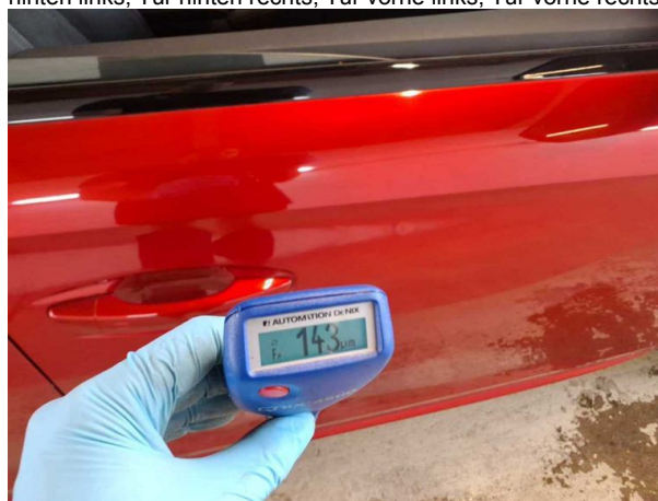
Nachlackierung 1: Seitenwand links, Seitenwand rechts, Tür hinten links, Tür hinten rechts, Tür vorne links, Tür vorne rechts
