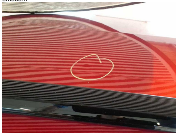
Beschädigung #11: Fahrzeugdach: Dach - Delle(n) - sanft instandsetzen
