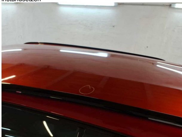
Beschädigung #11: Fahrzeugdach: Dach - Delle(n) - sanft instandsetzen
