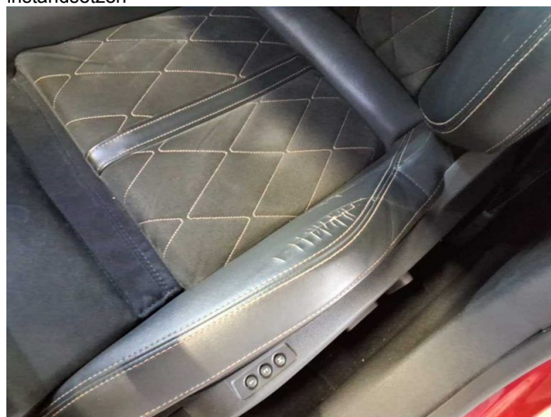
Beschädigung #10: Sitz vorn: Sitzbezug links - beschädigt - erneuern
