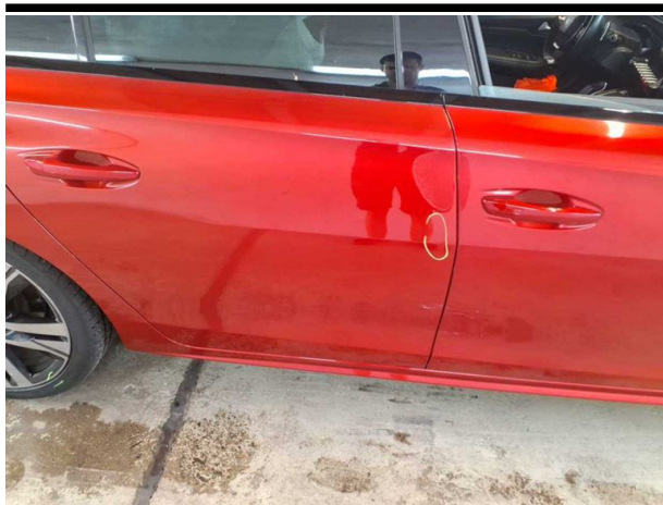
Beschädigung #9: Tür hinten rechts: Tür - Delle(n) - sanft instandsetzen
