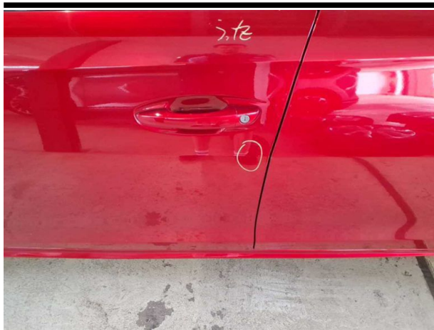
Beschädigung #5: Tür vorn links: Tür - Delle(n) - sanft instandsetzen
