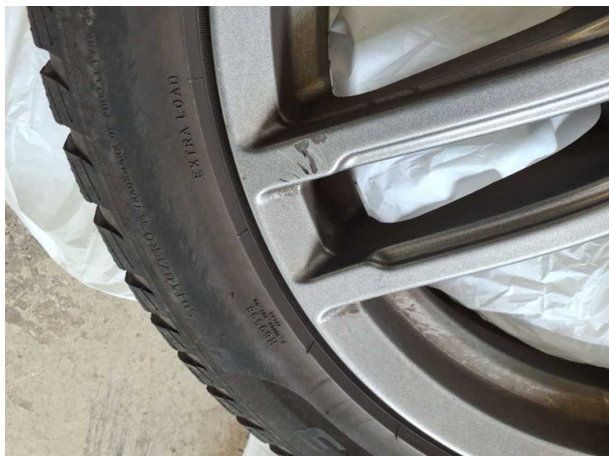
Beschädigung #1: 2.Radsatz: 3 Leichtmetallfelgen - verkratzt / verschürft - kein Abzug
