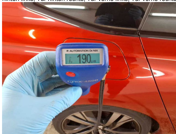
Nachlackierung 1: Seitenwand links, Seitenwand rechts, Tür hinten links, Tür hinten rechts, Tür vorne links, Tür vorne rechts
