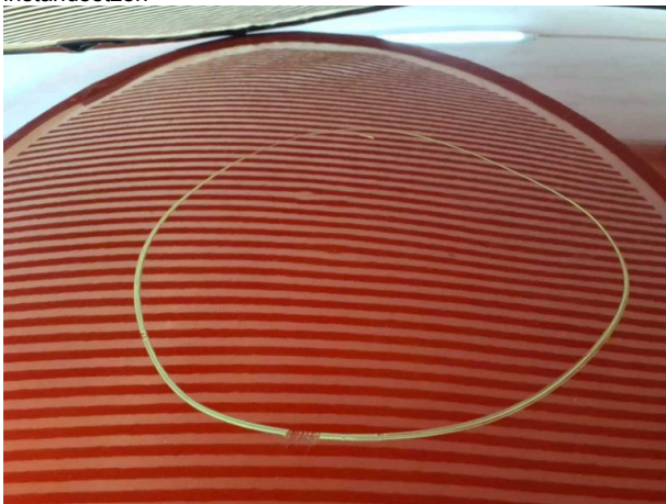
Beschädigung #11: Fahrzeugdach: Dach - Delle(n) - sanft instandsetzen
