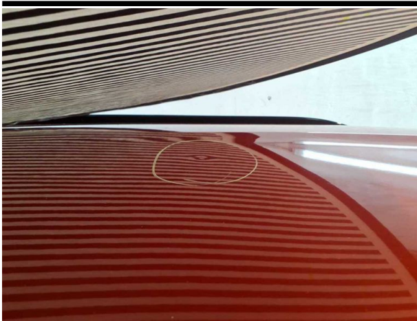
Beschädigung #11: Fahrzeugdach: Dach - Delle(n) - sanft instandsetzen
