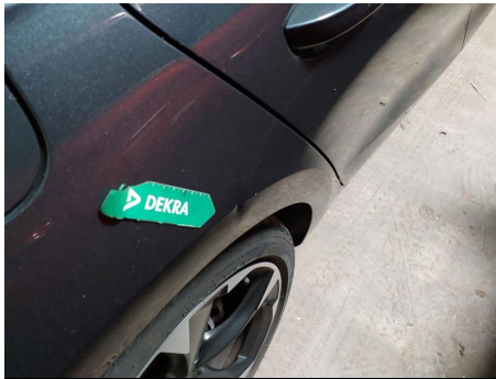
Aleta / Trasero Derecho / Abolladura
