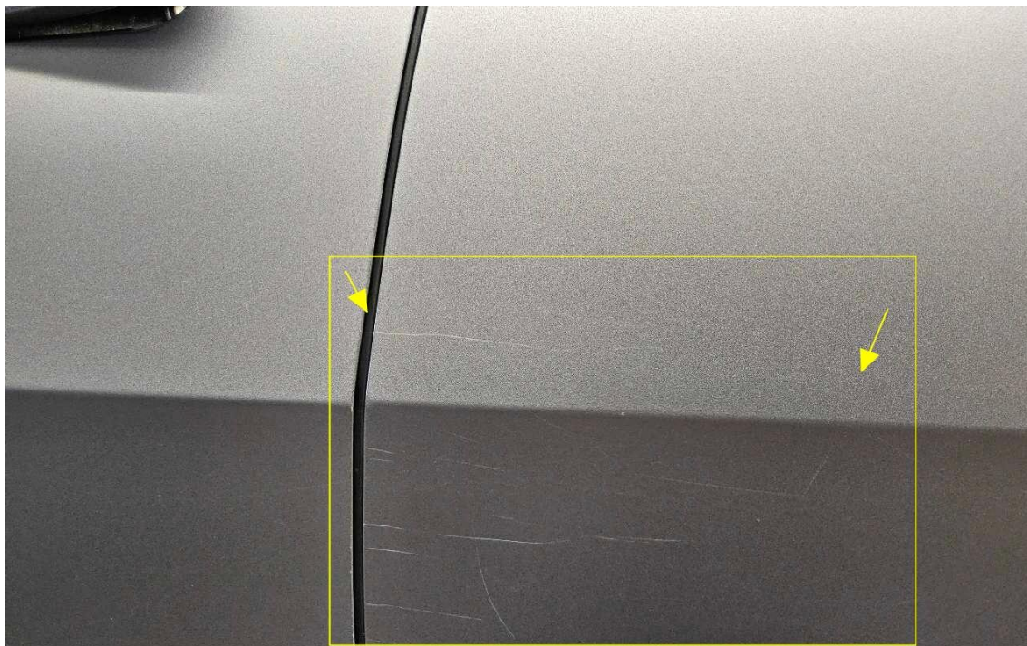
Bild 15 : Tür hinten links verschrammt
