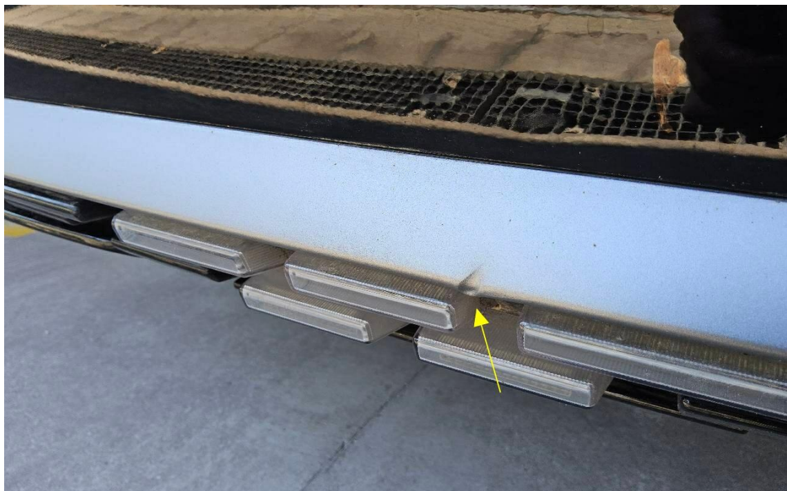
Bild 20 : Stoßfängerverkleidung hinten mehrfach verschrammt und verformt
