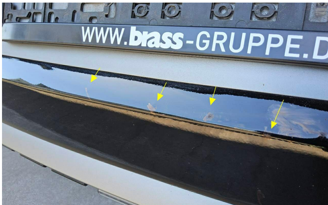
Bild 18 : Stoßfängerverkleidung hinten mehrfach verschrammt und verformt
