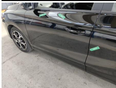
Tür / Vorne Links / Delle
