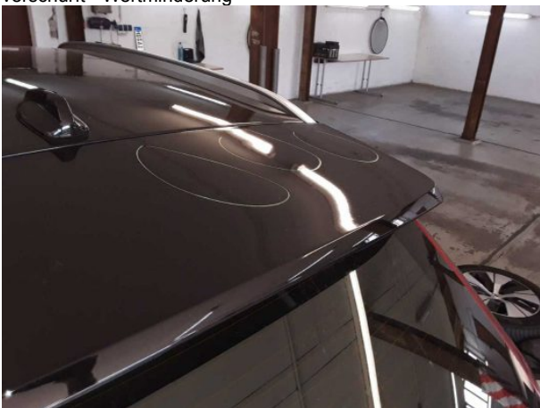
Beschädigung #7: Heckklappe/-tür: Heckspoiler - Delle(n) - sanft instandsetzen
