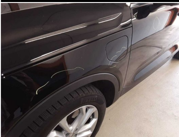
Beschädigung #8: Kotflügel links: Kotflügel links - verkratzt / verschürft - instandsetzen und lackieren
