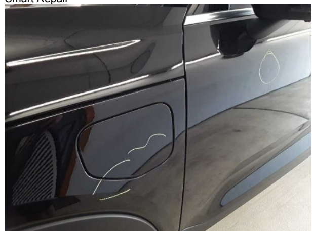
Beschädigung #5: Kraftstoffanlage: Tankdeckel - verkratzt / verschürft - Smart Repair
