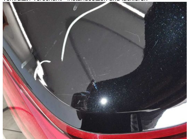
Beschädigung #11: Seitenwand links: Seitenwand - verkratzt / verschürft - instandsetzen und lackieren
