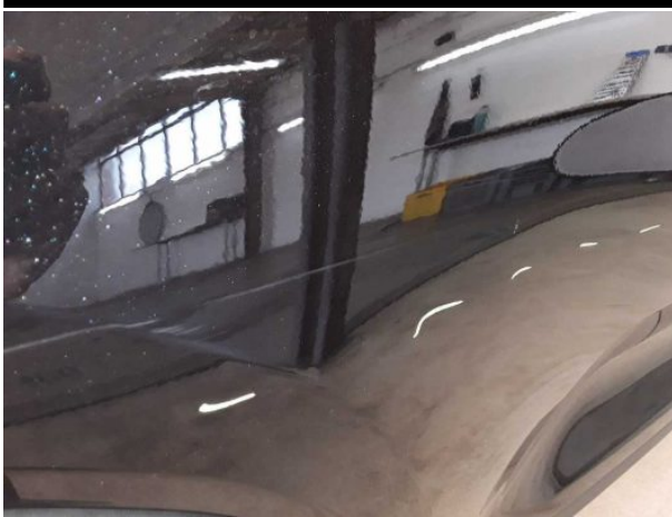
Beschädigung #3: Tür hinten rechts: Tür - Kratzer - auslegen / polieren
