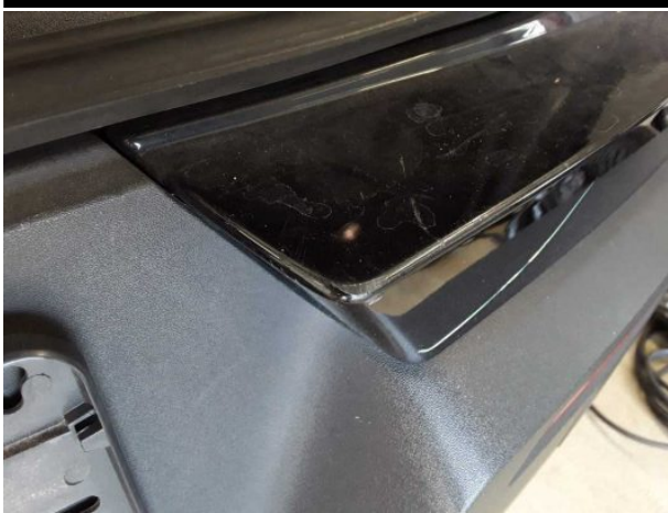
Beschädigung #9: Stossfänger hinten: Stossfänger hinten - verkratzt / verschürft - instandsetzen und lackieren
