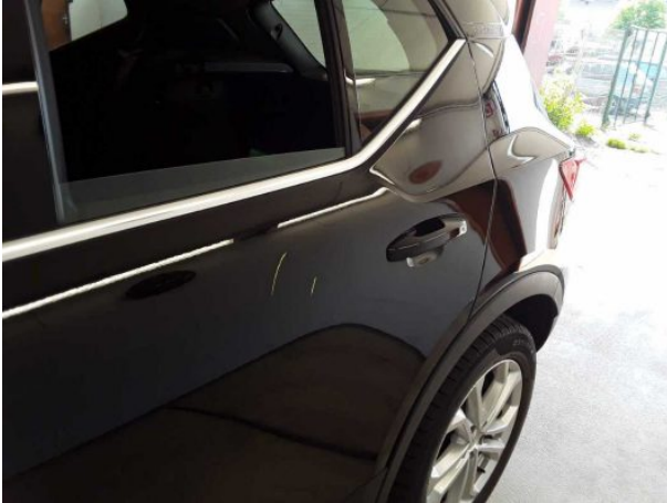
Beschädigung #1: Tür hinten links: Tür - Kratzer - auslegen / polieren
