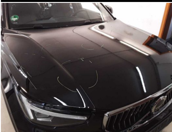
Beschädigung #12: Motorhaube: Motorhaube - verkratzt / verschürft - instandsetzen und lackieren
