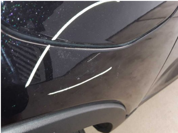
Beschädigung #8: Kotflügel links: Kotflügel links - verkratzt / verschürft - instandsetzen und lackieren
