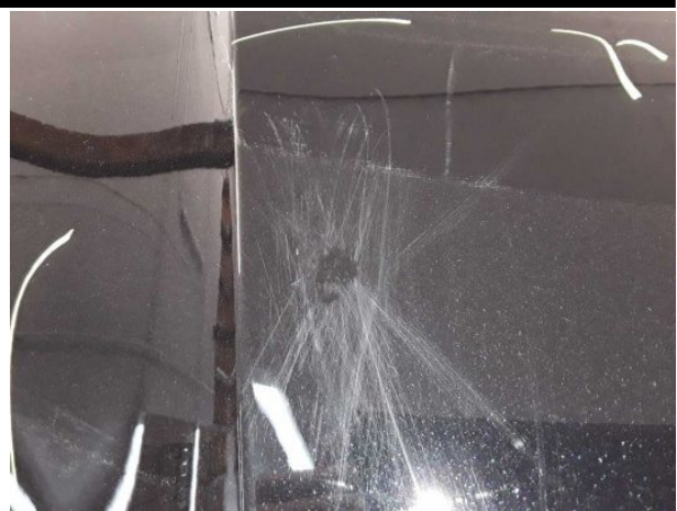
Beschädigung #12: Motorhaube: Motorhaube - verkratzt / verschürft - instandsetzen und lackieren
