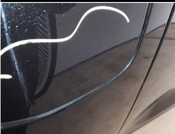
Beschädigung #5: Kraftstoffanlage: Tankdeckel - verkratzt / verschürft - Smart Repair
