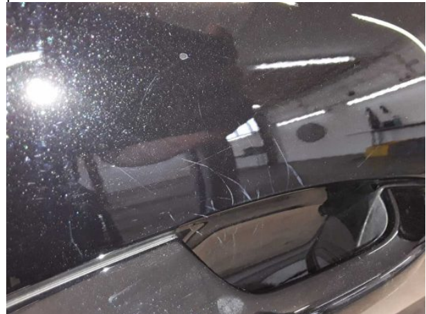
Beschädigung #2: Heckklappe/-tür: Heckklappe - Kratzer - auslegen / polieren
