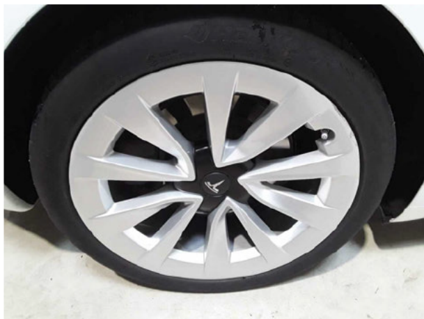
Beschädigung #6: Rad/Reifen: Leichtmetallfelge hinten rechts (Materialabrieb) - verkratzt / verschürft - erneuern
