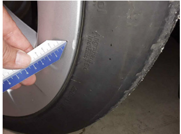
Beschädigung #4: Rad/Reifen: Leichtmetallfelge vorn rechts - Kratzer - Wertminderung
