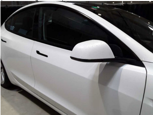
Beschädigung #2: Außenspiegel rechts: Abdeckkappe - Kratzer - Smart Repair
