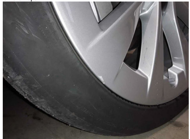
Beschädigung #4: Rad/Reifen: Leichtmetallfelge vorn rechts - Kratzer - Wertminderung
