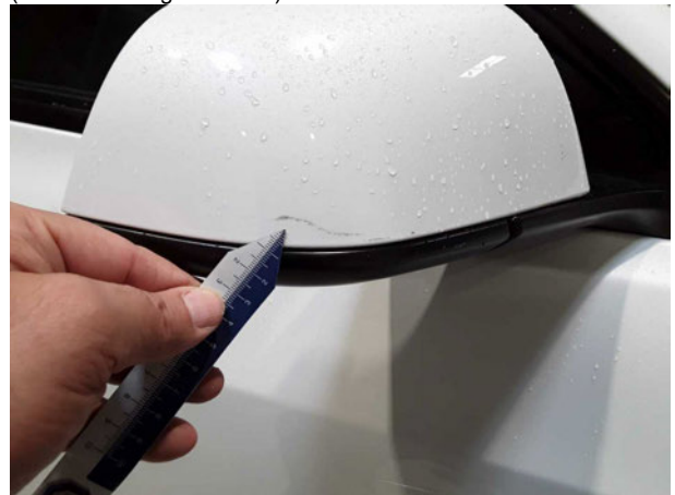
Beschädigung #2: Außenspiegel rechts: Abdeckkappe - Kratzer - Smart Repair
