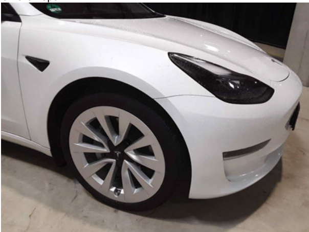
Beschädigung #4: Rad/Reifen: Leichtmetallfelge vorn rechts - Kratz... Wertminderung
