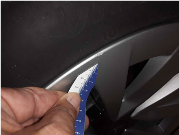
Beschädigung #4: Rad/Reifen: Leichtmetallfelge vorn rechts - Kratz... Wertminderung
