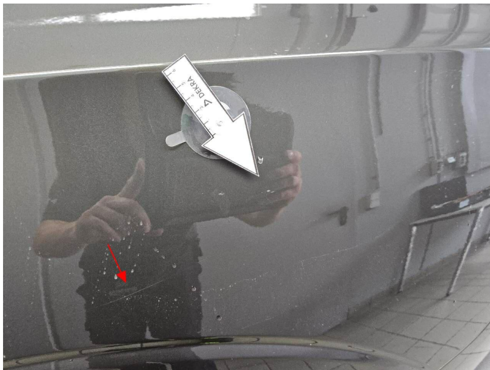
Bild 29 : Seitenteil hinten links Lackierung unterhalb, zerkratzt, lackieren
