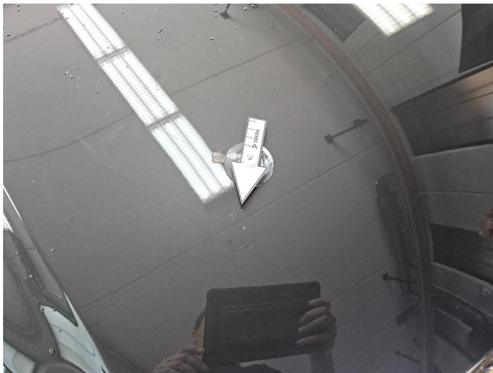
Bild 20 : Motorhaube Lackierung, Steinschlag
