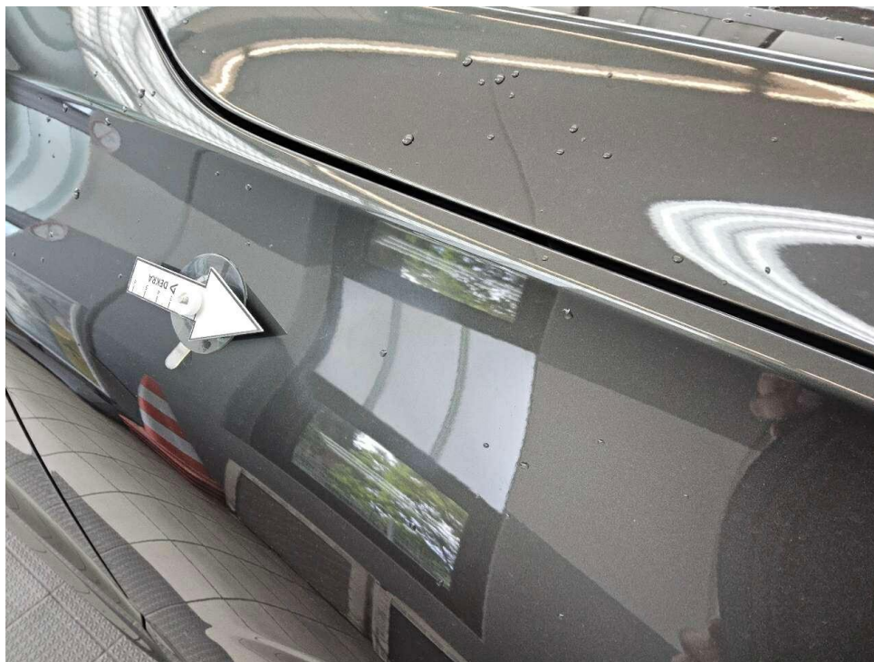
Bild 22 : Kotflügel vorne rechts, Lackierung fleckig
