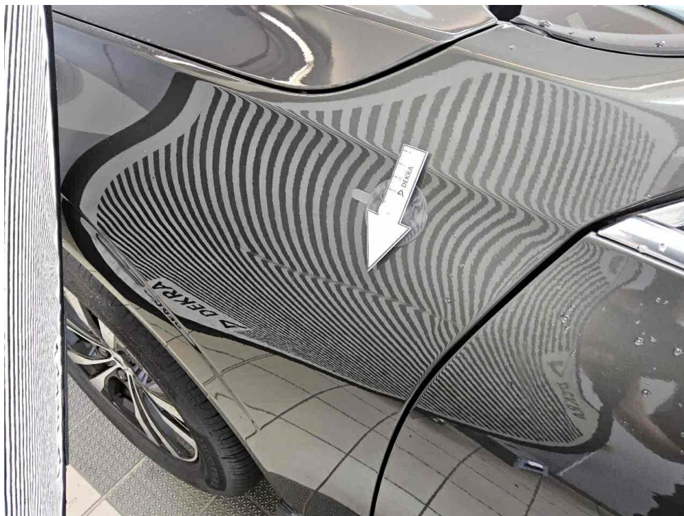
Bild 32 : Kotflügel vorne links, eingedellt, eingedrückt
