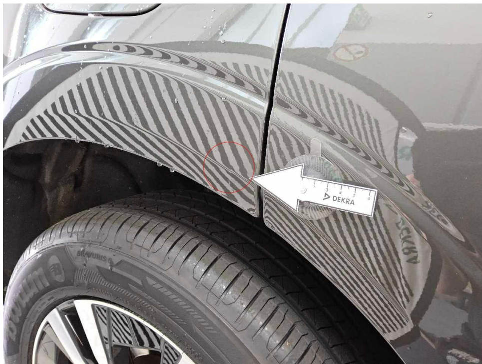
Bild 25 : Seitenteil hinten rechts, eingedellt, mit leichter Lackbeschädigung
