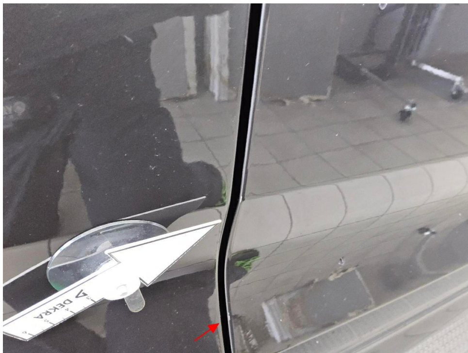
Bild 24 : Tür vorne rechts Türkante, zerkratzt
