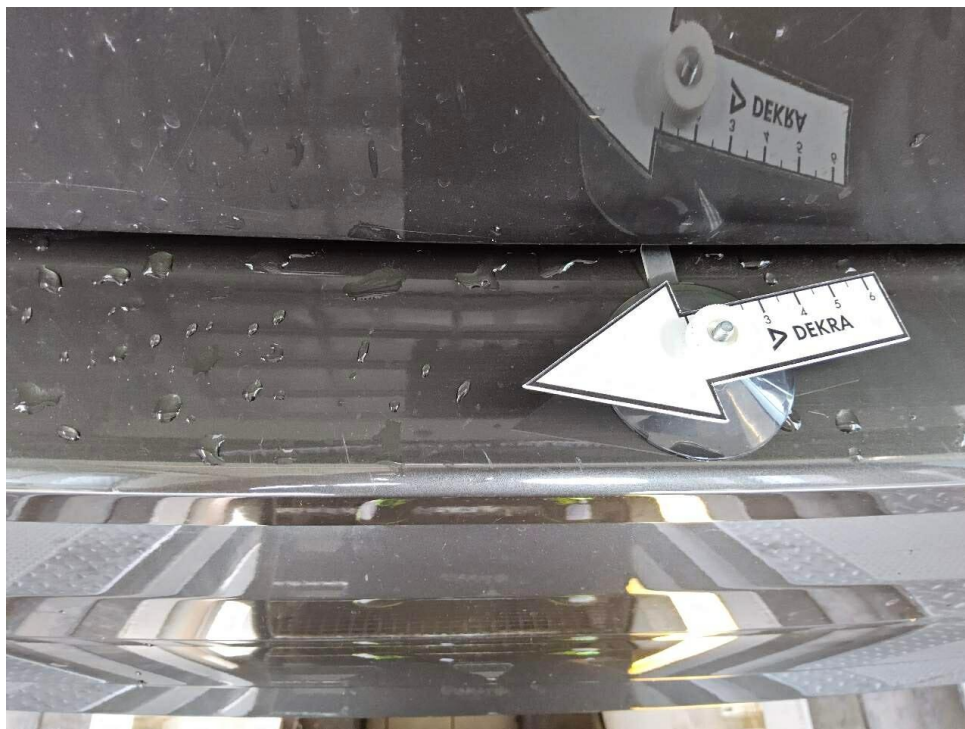
Bild 27 : Stoßfänger hinten Ladekante, zerkratzt
