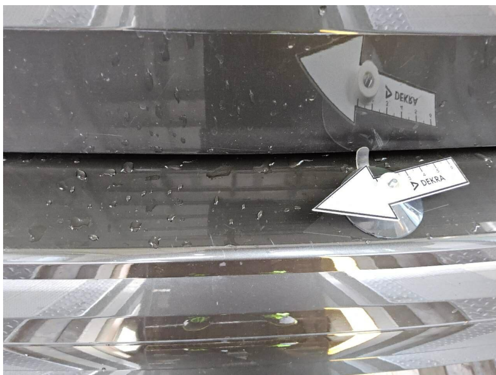
Bild 28 : Stoßfänger hinten Ladekante, zerkratzt
