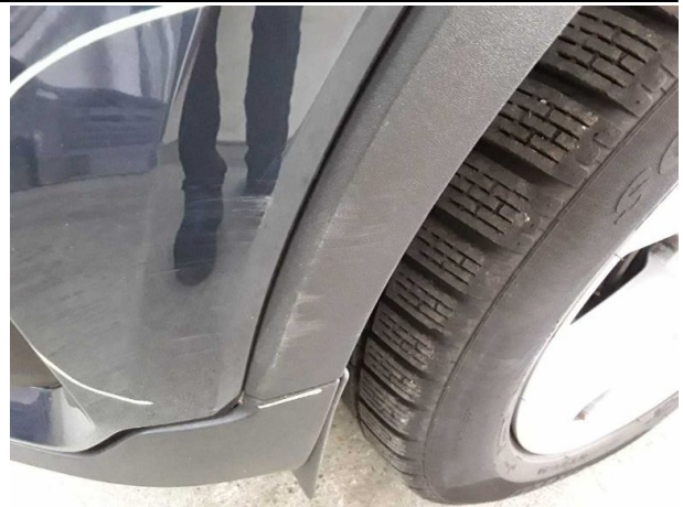
Beschädigung #6: Kotflügel links: Radhausverbreiterung - verkratzt / verschürft - erneuern
