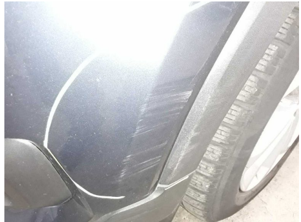
Beschädigung #10: Stossfänger vorn: Stossfänger vorn - verkratzt / verschürft - instandsetzen und lackieren
