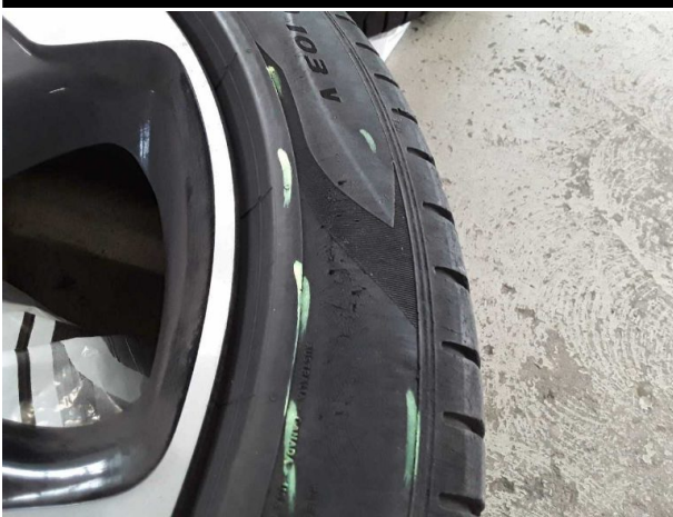
Beschädigung #8: Rad/Reifen: Reifen vorn - beschädigt - erneuern
