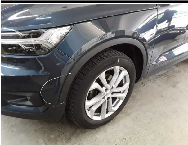
Beschädigung #6: Kotflügel links: Radhausverbreiterung - verkratzt / verschürft - erneuern
