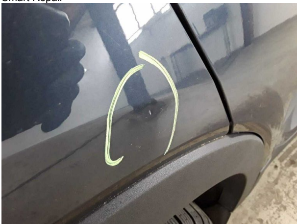
Beschädigung #5: Seitenwand rechts: Seitenwand - Delle / Lackschaden - Smart Repair
