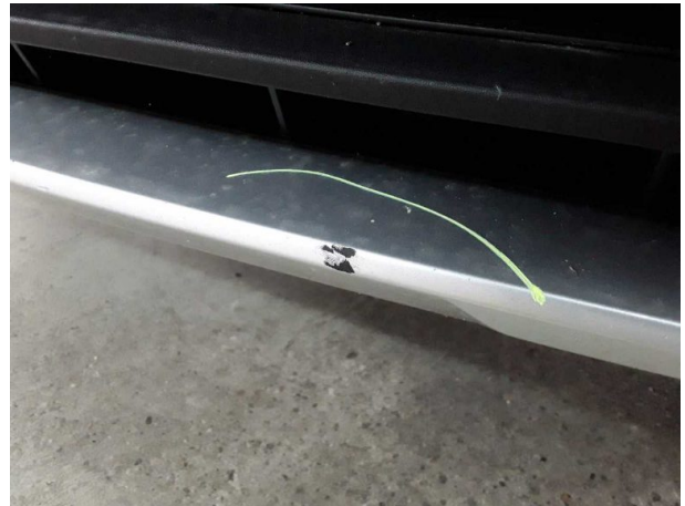
Beschädigung #7: Stossfänger vorn: Spoiler - verkratzt / verschürft - Smart Repair
