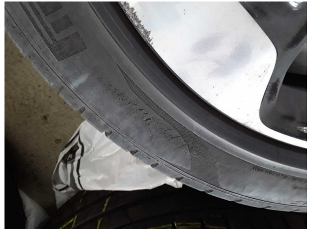
Beschädigung #8: Rad/Reifen: Reifen vorn - beschädigt - erneuern
