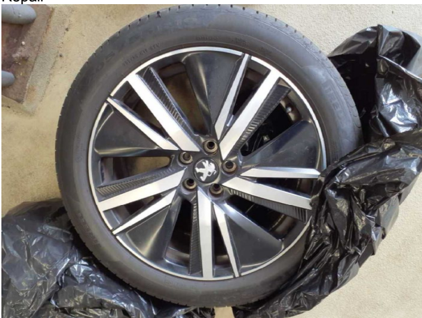
Beschädigung #5: 2.Radsatz: 2 Leichtmetallfelgen - verkratzt / verschürft - Wertminderung
