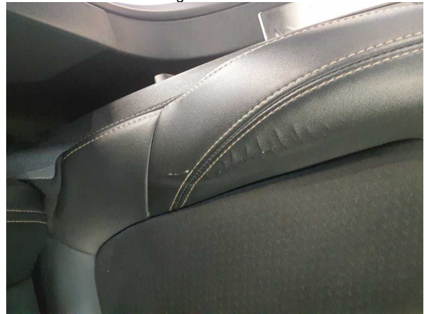
Beschädigung #6: Sitz vorn: Sitzbezug links - porös / rissig - erneuern
