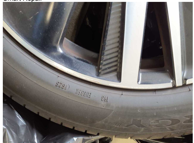
Beschädigung #5: 2.Radsatz: 2 Leichtmetallfelgen - verkratzt / verschürft - Wertminderung
