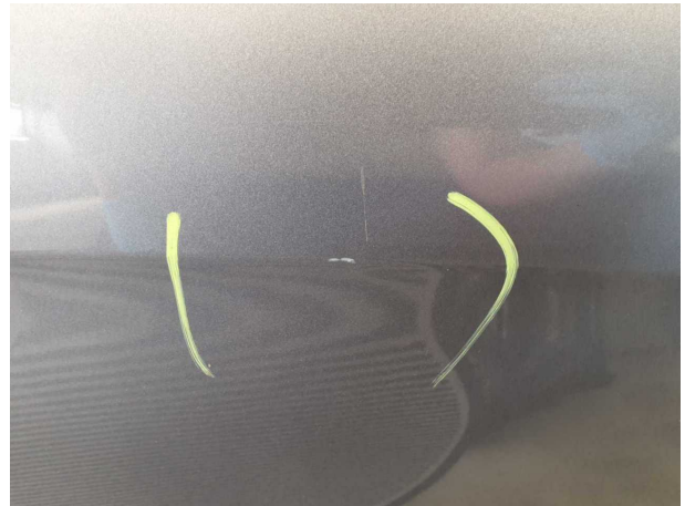
Beschädigung #8: Tür hinten rechts: Tür - Delle / Lackschaden... - instandsetzen und lackieren
