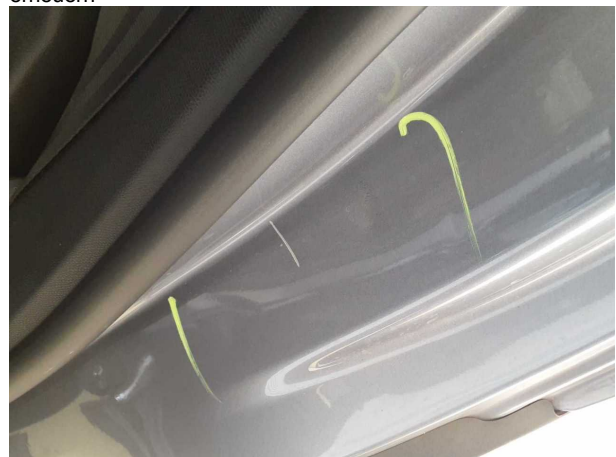
Beschädigung #7: Seitenwand links: Einstieg - Delle / Lackschaden - instandsetzen und lackieren
