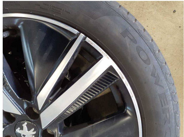
Beschädigung #5: 2.Radsatz: 2 Leichtmetallfelgen - verkratzt / verschürft - Wertminderung
