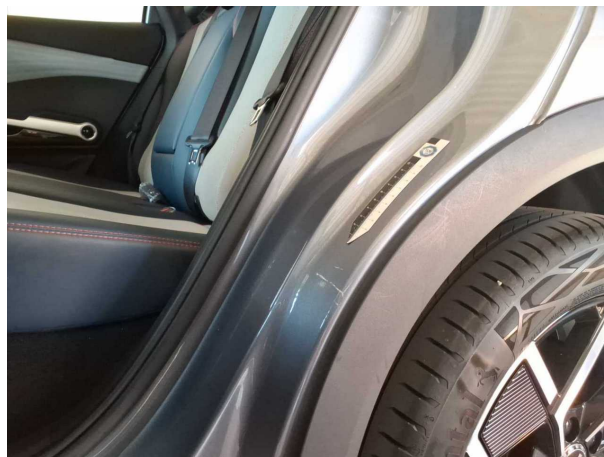
Beschädigung #1: Seitenwand links: Einstieg - Kratzer - Smart Repair
