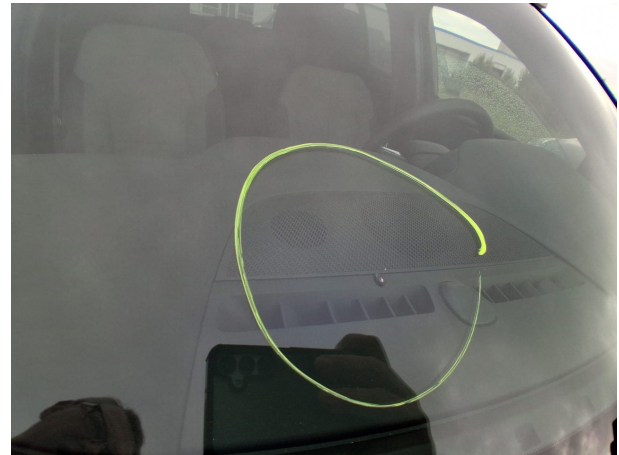
Beschädigung #4: Verglasung: Frontscheibe - Steinschlag - erneuern
