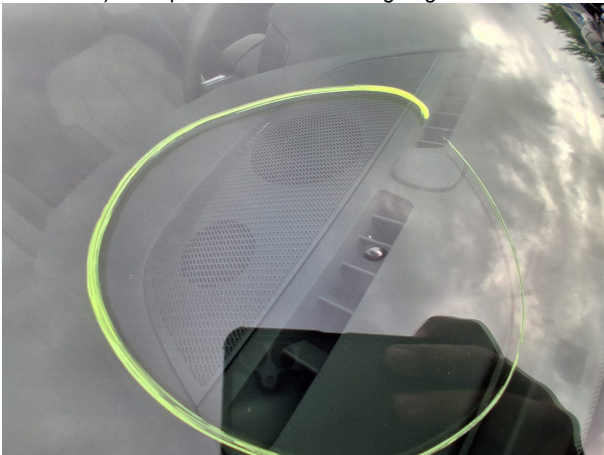
Beschädigung #4: Verglasung: Frontscheibe - Steinschlag - erneuern
