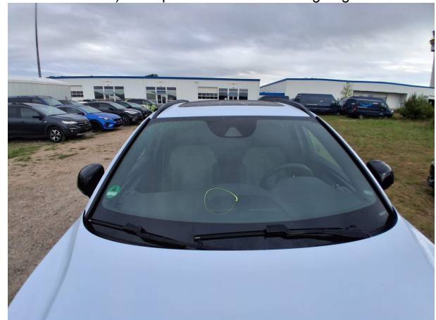
Beschädigung #4: Verglasung: Frontscheibe - Steinschlag - erneuern
