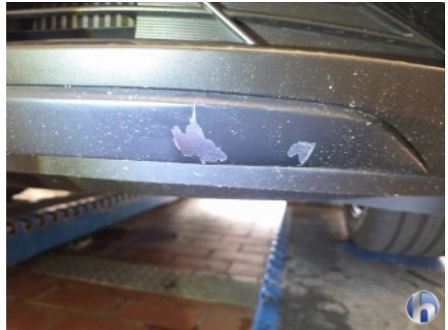
5. Frontspoiler Lackabplatzer - Smart Repair
