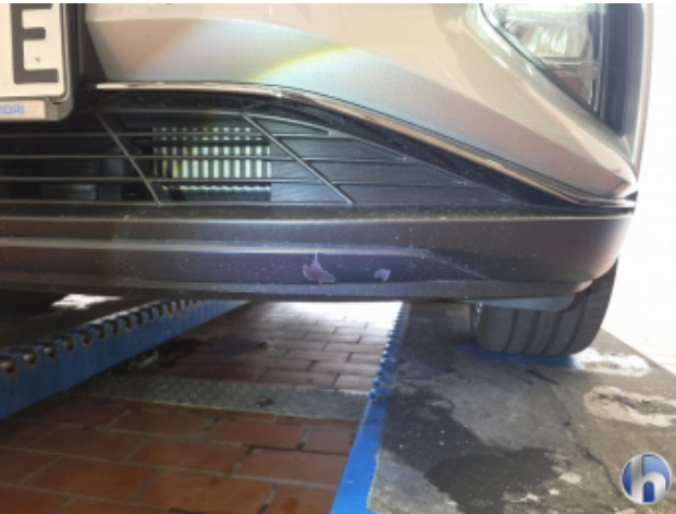
5. Frontspoiler Lackabplatzer - Smart Repair
