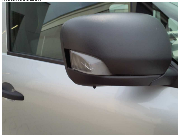
Beschädigung #3: Blinkleuchte: Spiegel rechts - gebrochen / gerissen - erneuern
