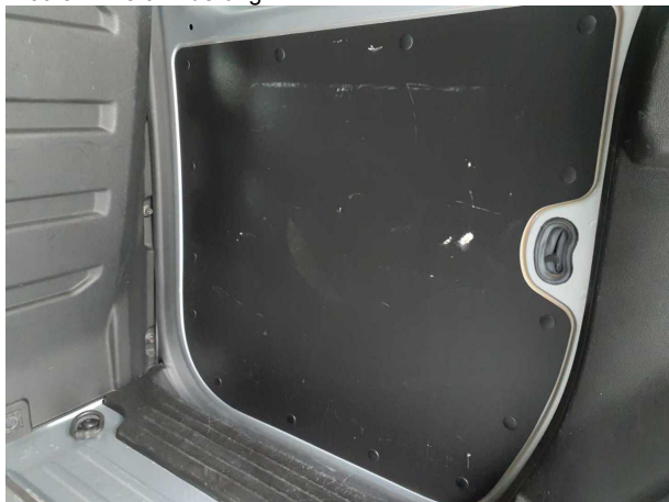
Beschädigung #8: Verkleidungen/Abdeckungen: Türverkleidung hinten rechts - Kratzer - erneuern
