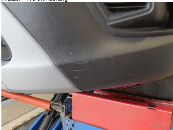
Beschädigung #6: Stossfänger vorn: Stossfänger vorn (unlackiert) - Kratzer - Wertminderung
