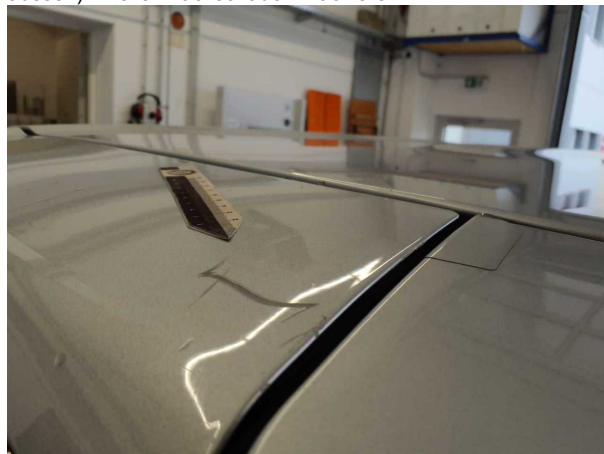
Beschädigung #13: Heckklappe/-tür: Hecktür links (Innen und aussen) - Delle / Lackschaden - lackieren
