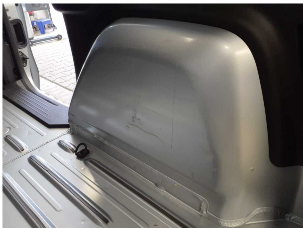
Beschädigung #12: Verkleidungen/Abdeckungen: Laderaumverkleidung rechts - Delle / Lackschaden - instandsetzen und
