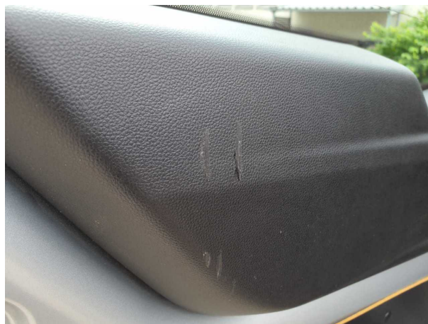
Beschädigung #9: Verkleidungen/Abdeckungen: Heckdeckel, Innenverkleidung - Kratzer - erneuern
