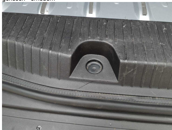
Beschädigung #4: Verkleidungen/Abdeckungen: Innenverkleidung hinten - gebrochen / gerissen - erneuern
