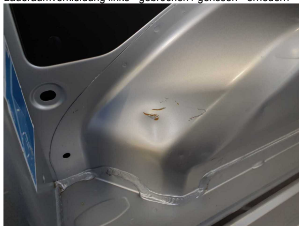
Beschädigung #11: Verkleidungen/Abdeckungen: Laderaumverkleidung links - Delle / Lackschaden - instandsetzen
