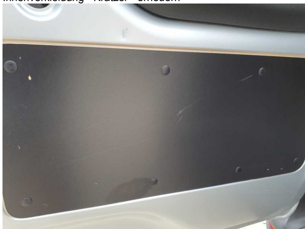
Beschädigung #9: Verkleidungen/Abdeckungen: Heckdeckel, Innenverkleidung - Kratzer - erneuern
