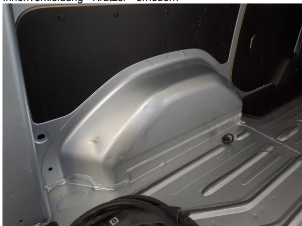
Beschädigung #11: Verkleidungen/Abdeckungen: Laderaumverkleidung links - Delle / Lackschaden - instandsetzen und
