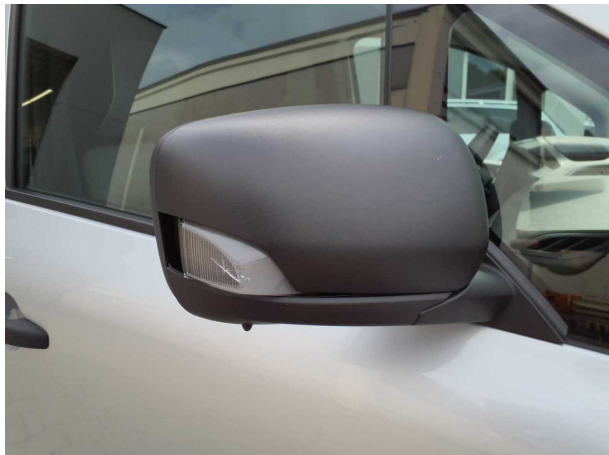
Beschädigung #1: Außenspiegel rechts: Abdeckkappe - gebrochen / gerissen - erneuern
