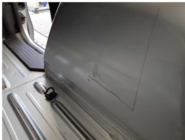
Beschädigung #12: Verkleidungen/Abdeckungen: Laderaumverkleidung rechts - Delle / Lackschaden - instandsetzen
