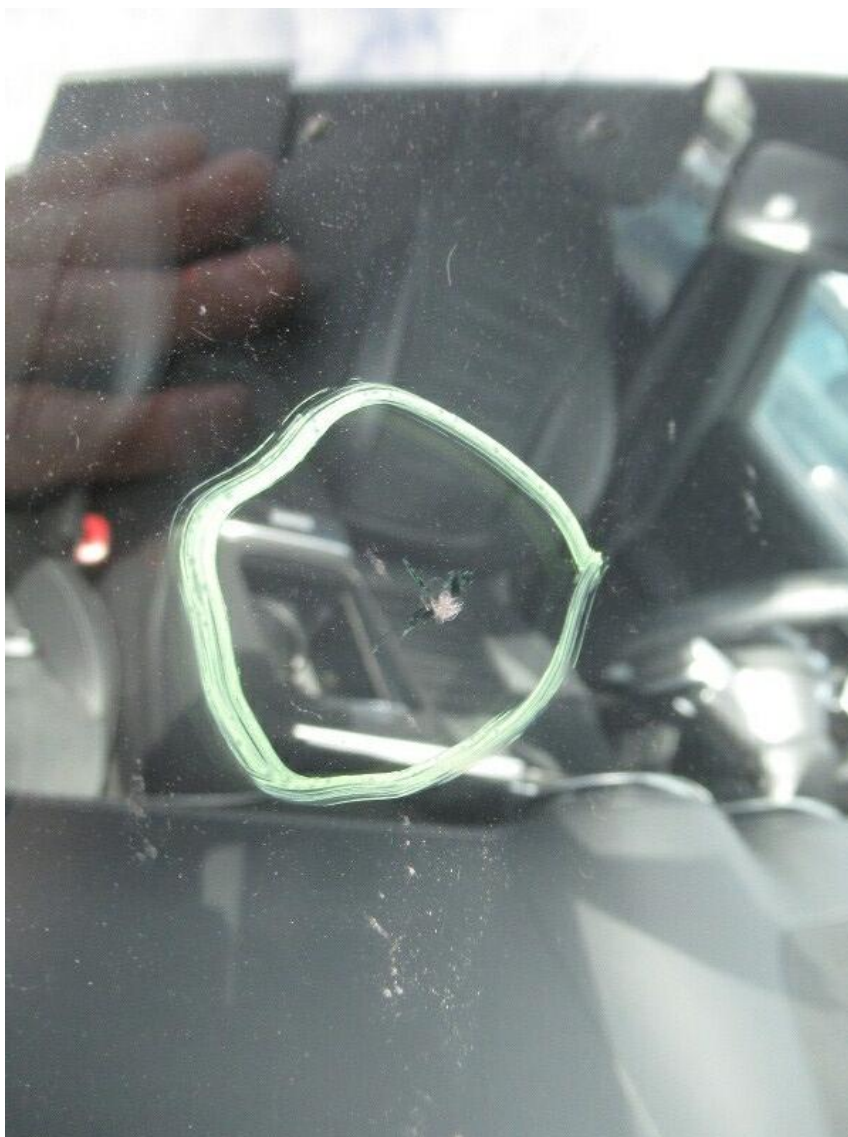
Bild 13 : Frontscheibe Steinschlag mit Rissbildung
