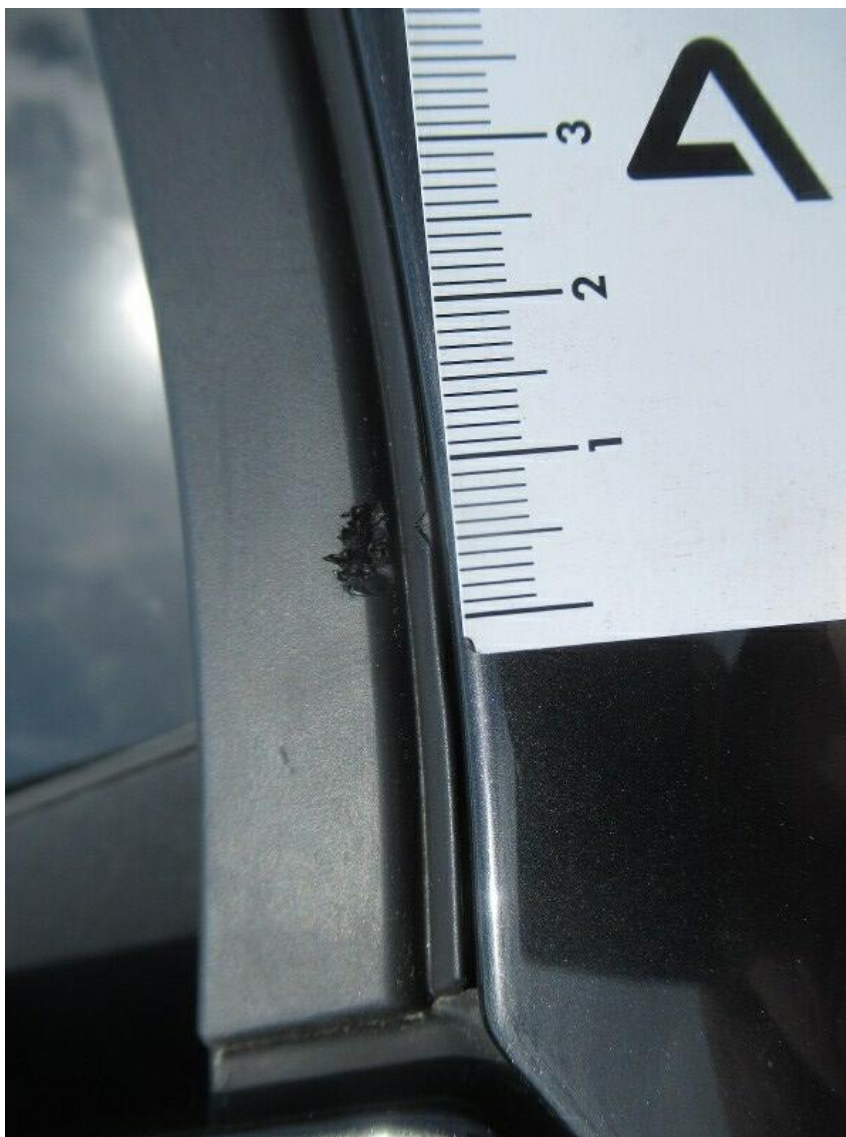
Bild 17 : Abdeckung Frontscheibe links beschädigt
