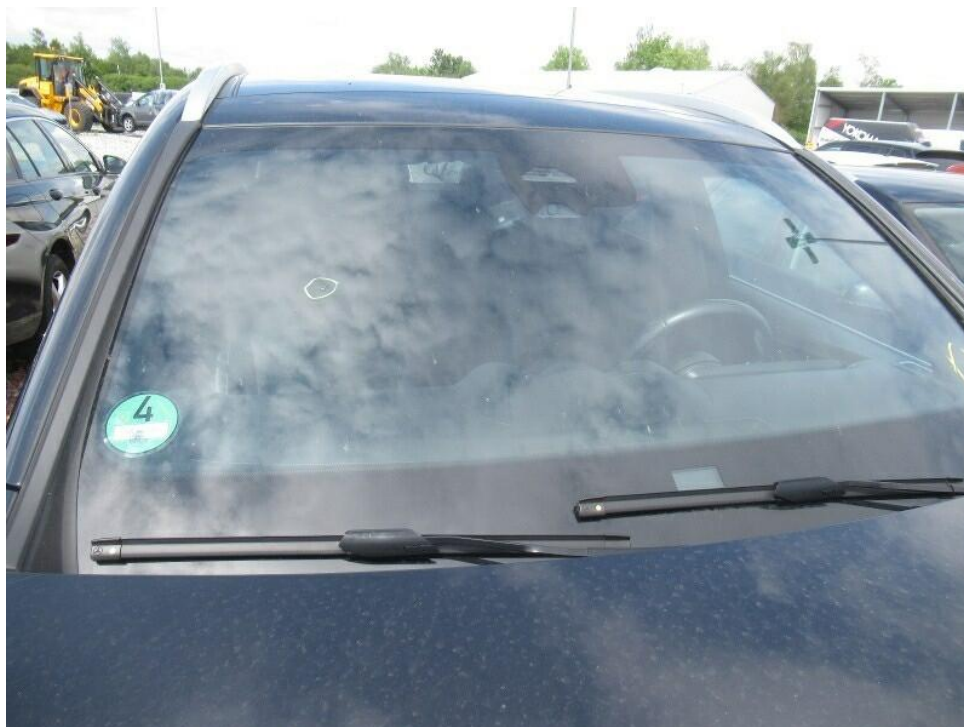
Bild 12 : Frontscheibe Steinschlag mit Rissbildung
