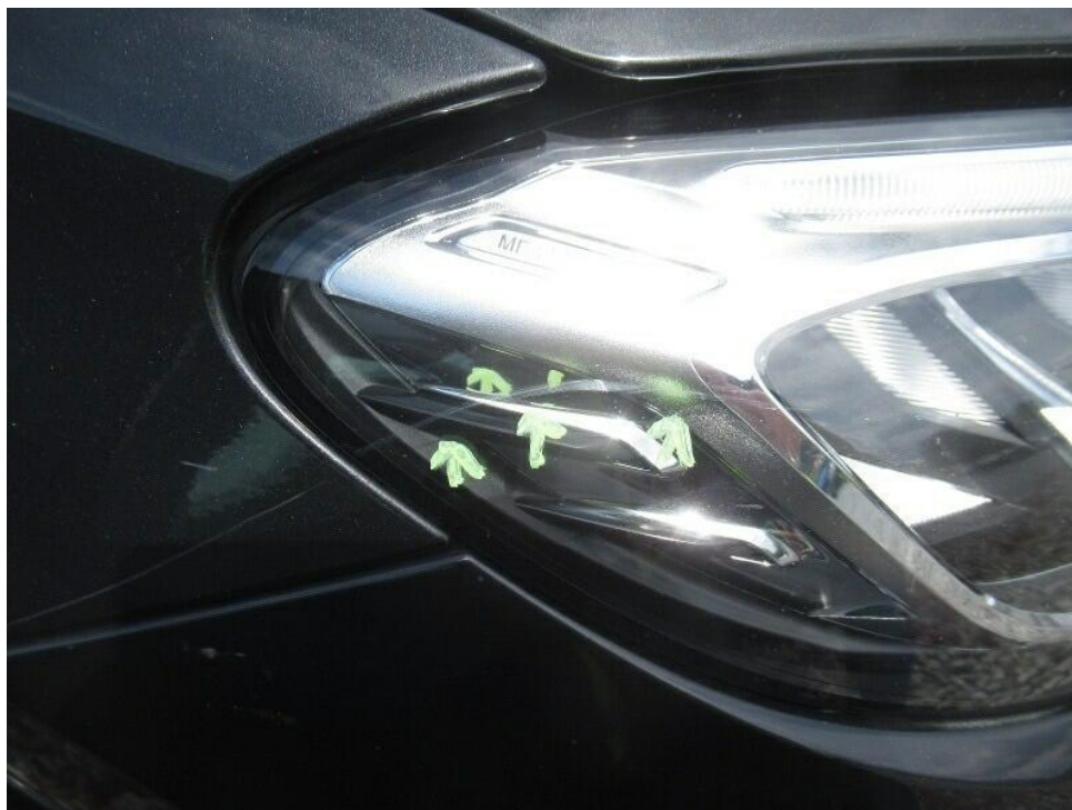
Bild 16 : Kotflügel vorne rechts verformt, Radlaufblende beschädigt, Scheinwerfer vorne rechts zerkratzt
