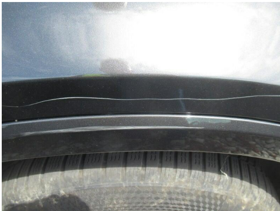
Bild 14 : Kotflügel vorne rechts verformt, Radlaufblende beschädigt, Scheinwerfer vorne rechts zerkratzt
