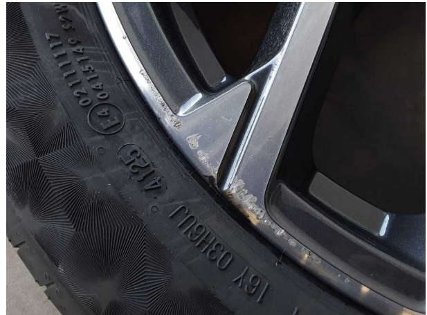
Beschädigung #6: 2.Radsatz: 1 Leichtmetallfelge - verkratzt / verschürft - Wertminderung
