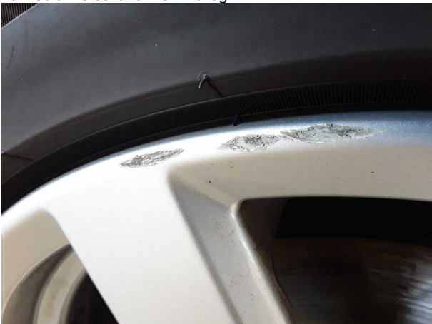
Beschädigung #3: Rad/Reifen: Leichtmetallfelge vorn rechts - verkratzt / verschürft - kein Abzug
