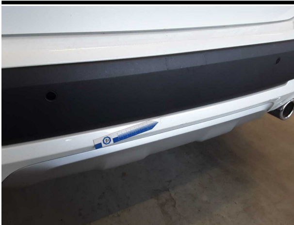
Beschädigung #7: Stossfänger hinten: Spoiler - verkratzt / verschürft - erneuern
