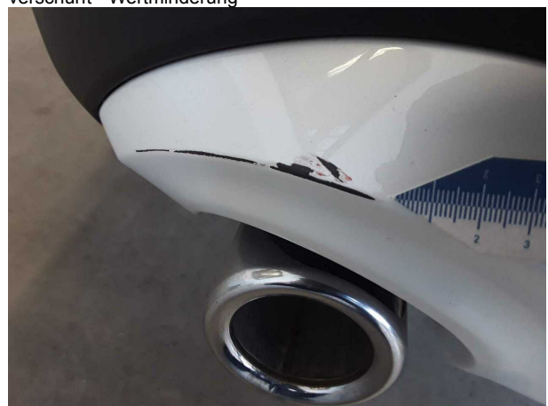
Beschädigung #7: Stossfänger hinten: Spoiler - verkratzt / verschürft - erneuern
