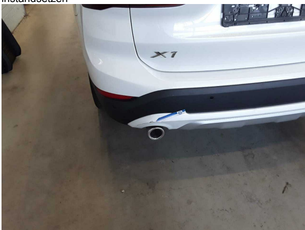
Beschädigung #7: Stossfänger hinten: Spoiler - verkratzt / verschürft - erneuern
