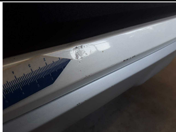
Beschädigung #7: Stossfänger hinten: Spoiler - verkratzt / verschürft - erneuern
