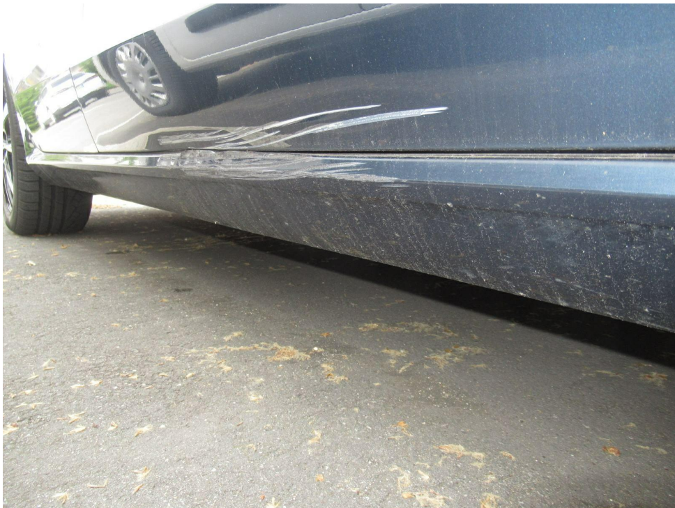
Bild 11 : Schaden im Bereich der Tür und Türschweller vorne rechts
