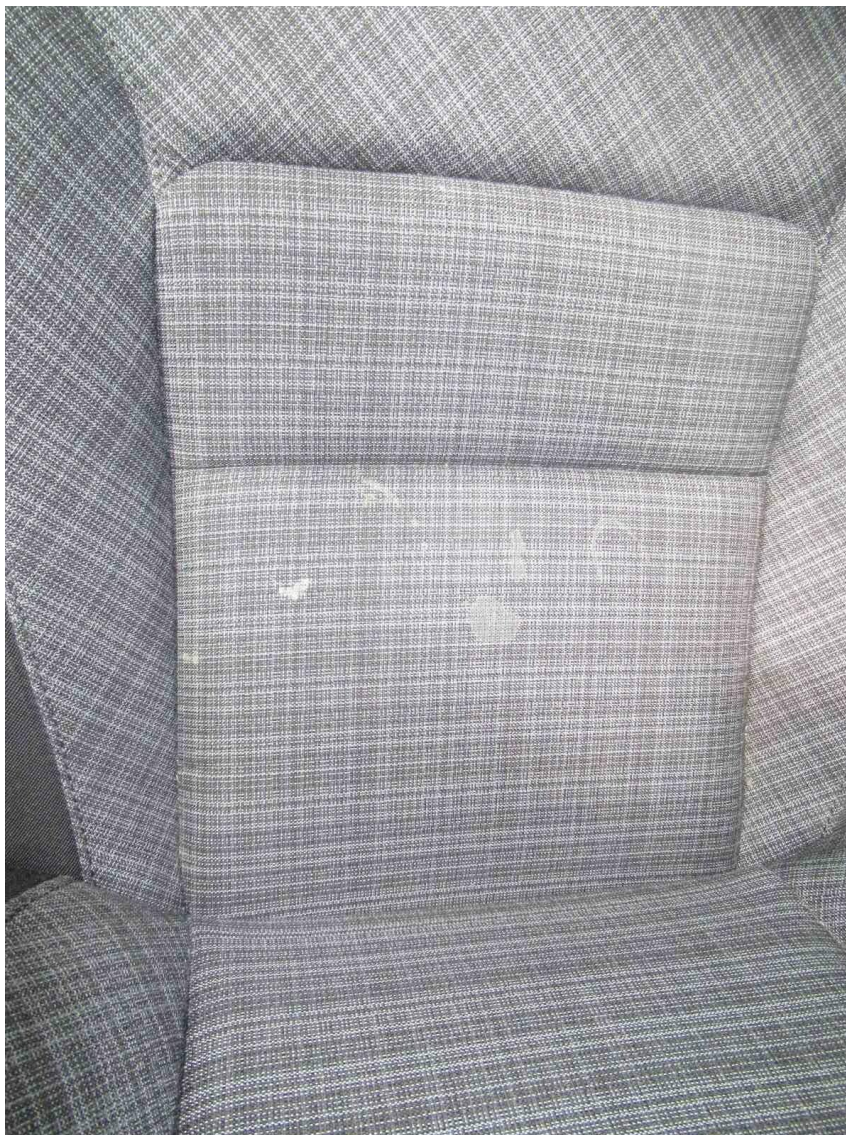
Bild 9 : Sitzbezüge vorne links und rechts verschmutzt, fleckig
