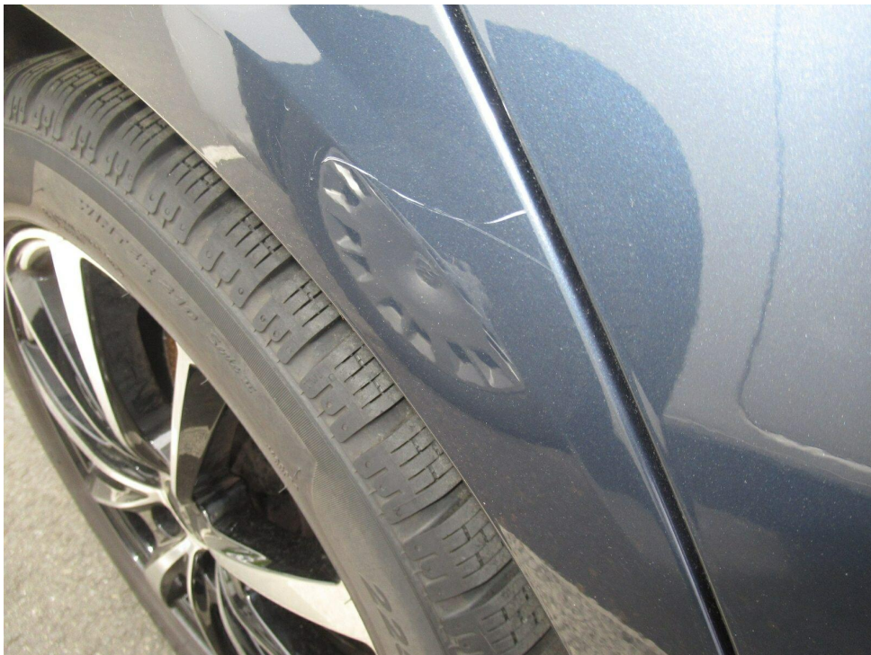
Bild 13 : Seitenwand rechts zerkratzt
