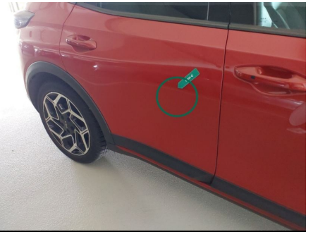
Tür / Hinten Rechts / Delle
