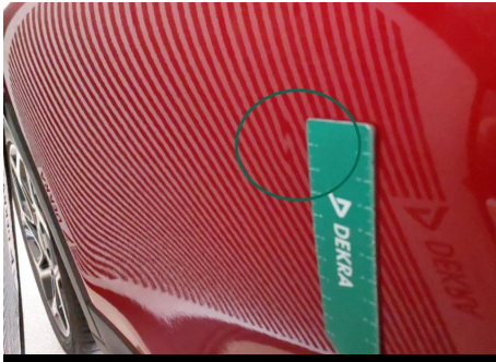
Tür / Hinten Rechts / Delle
