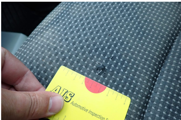
Beschädigung 4: Sitz vorn: Sitzbezug rechts - Brandloch - erneuern
