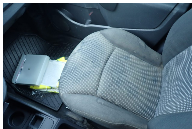
Beschädigung 4: Sitz vorn: Sitzbezug rechts - Brandloch - erneuern
