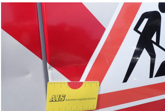
Beschädigung 6: Heckklappe/-tür: Hecktür rechts - Delle / Lackschaden - instandsetzen und lackieren
