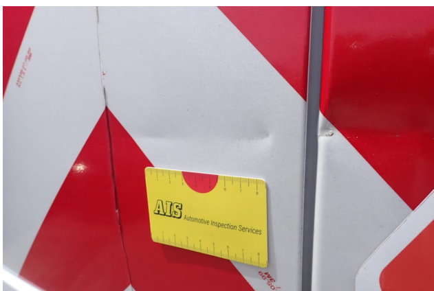
Beschädigung 5: Heckklappe/-tür: Hecktür links - Delle / Lackschaden - instandsetzen und lackieren
