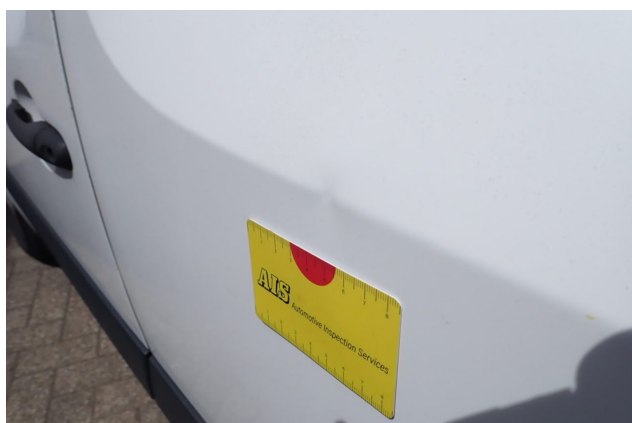
Beschädigung 3: Seitenwand links: Seitenwand - Delle(n) - Smart Repair
