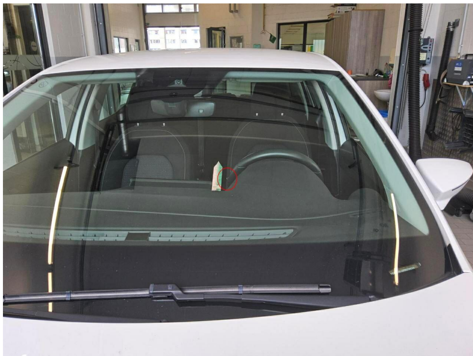
Bild 14 : Frontscheibe, gerissen, erneuern
