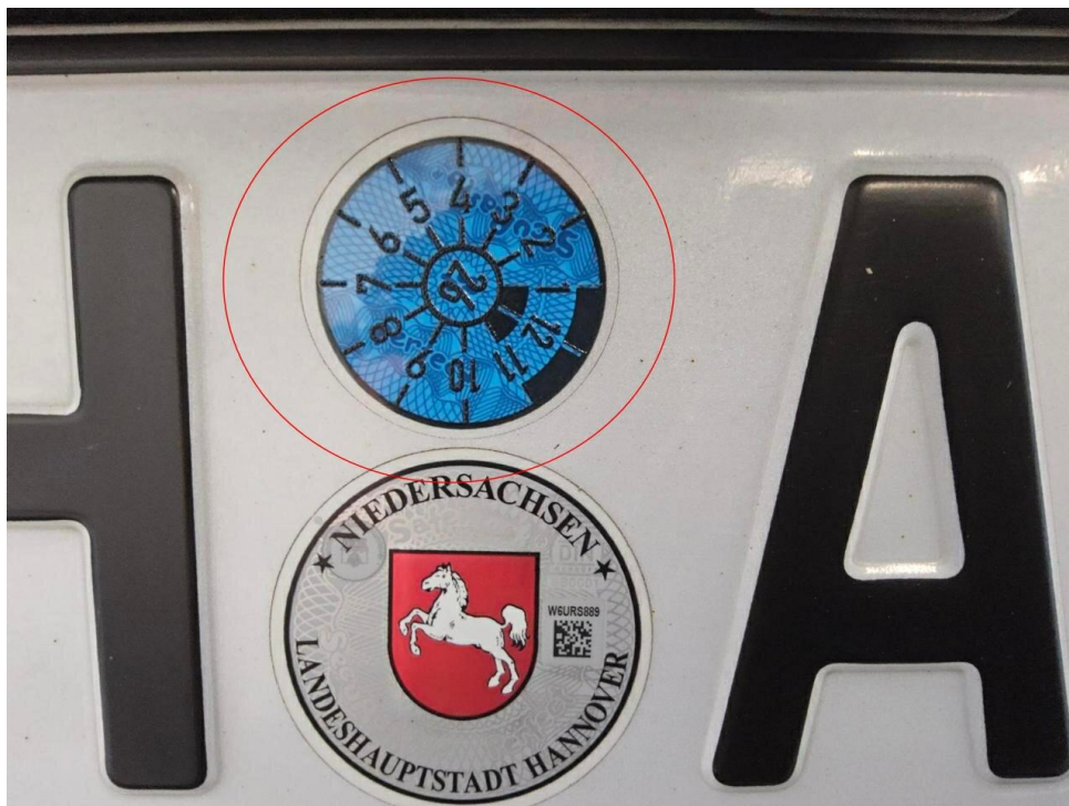
Bild 20 : HU/AU, überfällig, durchführen
