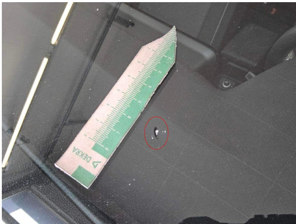
Bild 15 : Frontscheibe, gerissen, erneuern
