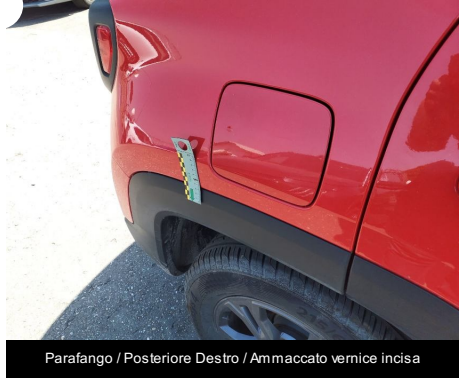
Parafango / Posteriore Destro / Ammaccato vernice incisa
