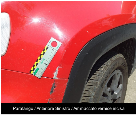
Parafango / Anteriore Sinistro / Ammaccato vernice incisa
