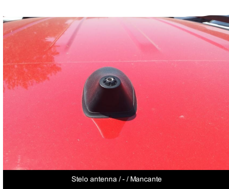
Stelo antenna / - / Mancante
