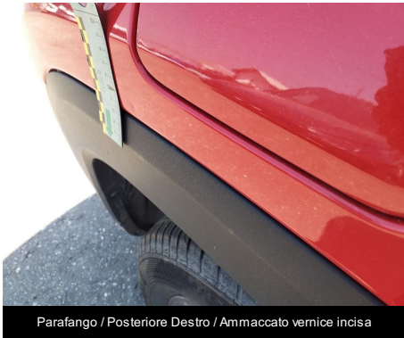
Parafango / Posteriore Destro / Ammaccato vernice incisa
