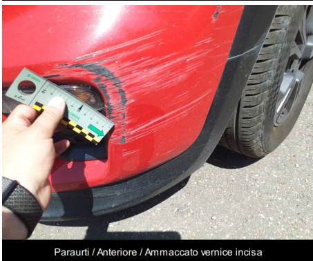
Paraurti / Anteriore / Ammaccato vernice incisa
