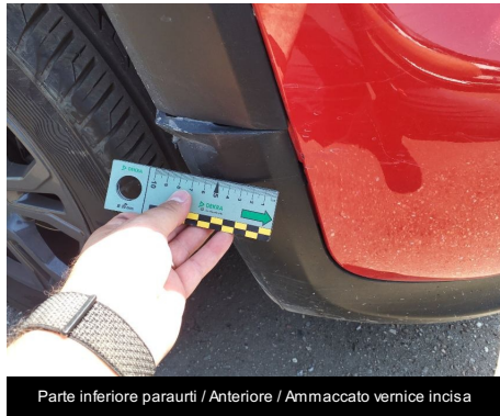
Parte inferiore paraurti / Anteriore / Ammaccato vernice incisa
