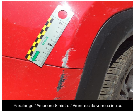
Parafango / Anteriore Sinistro / Ammaccato vernice incisa
