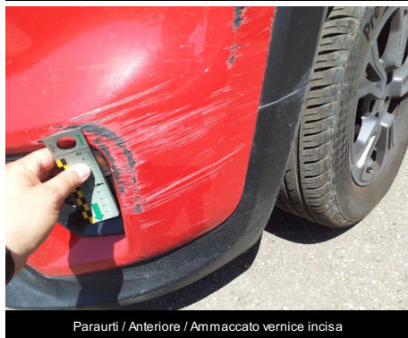
Paraurti / Anteriore / Ammaccato vernice incisa
