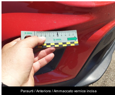
Paraurti / Anteriore / Ammaccato vernice incisa
