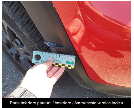
Parte inferiore paraurti / Anteriore / Ammaccato vernice incisa
