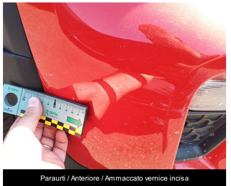
Paraurti / Anteriore / Ammaccato vernice incisa
