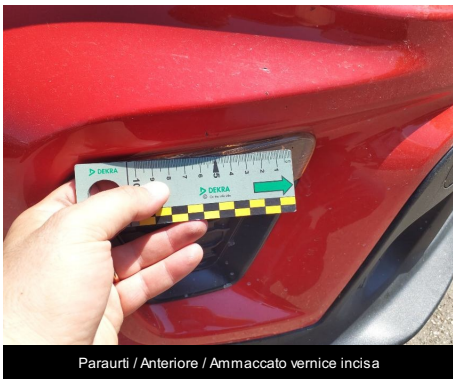
Paraurti / Anteriore / Ammaccato vernice incisa
