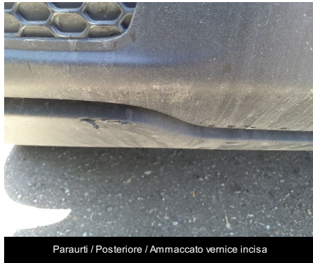
Paraurti / Posteriore / Ammaccato vernice incisa
