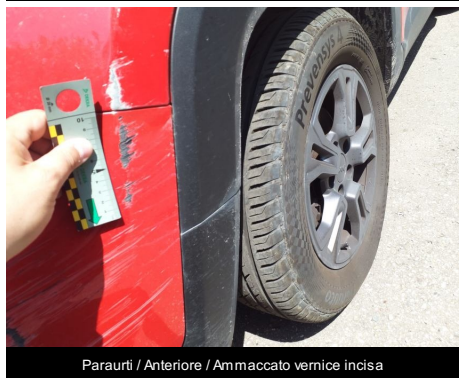
Paraurti / Anteriore / Ammaccato vernice incisa
