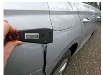
Lackstärke Seitenwand hinten rechts
