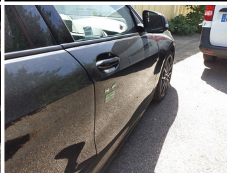
Porte / Avant Droit / Enfoncement
