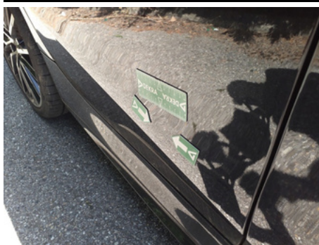
Porte / Arrière Droit / Enfoncement
