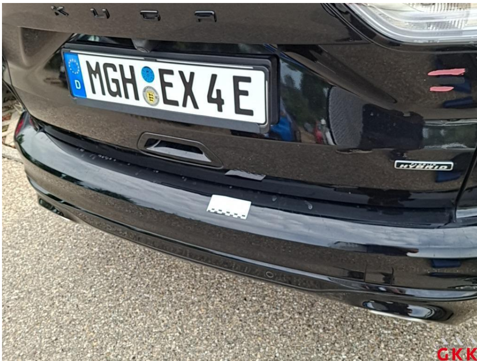
Bild 24. Stoßfänger hinten, Verkleidung oberhalb -lackiert-, beschädigt, ersetzen
