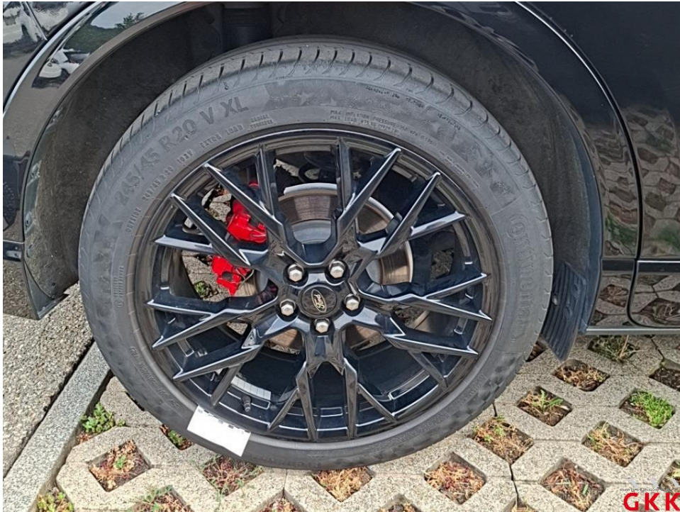
Bild 27. LM-Rad, hinten rechts, Materialabtrag, ersetzen
