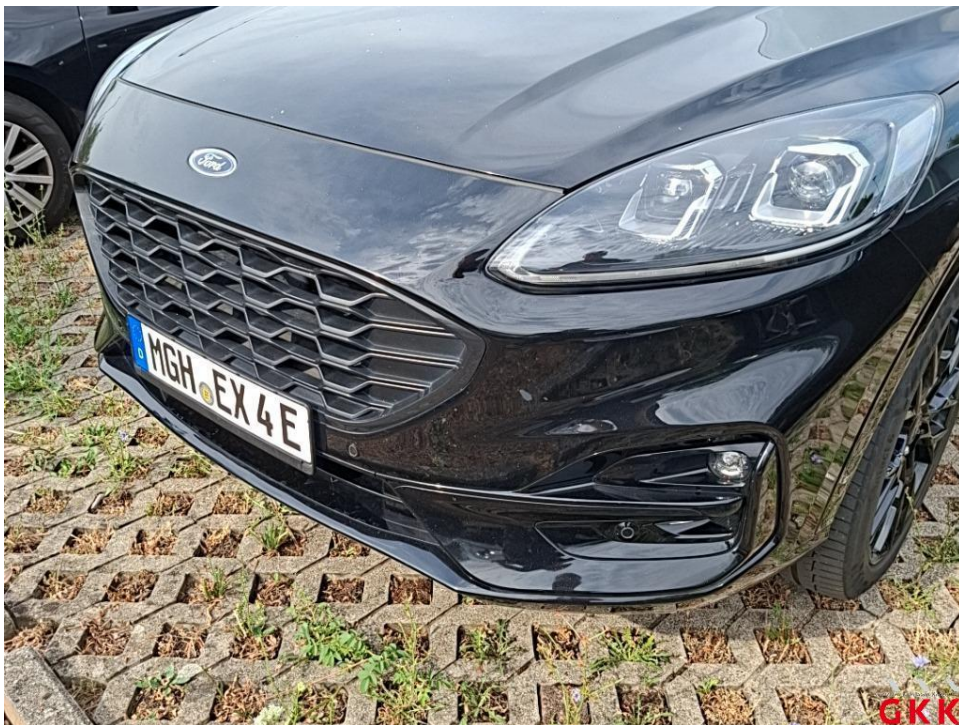
Bild 30. Stoßfänger vorne, Verkleidung -lackiert-, Steinschlag und Kratzer, lackieren
