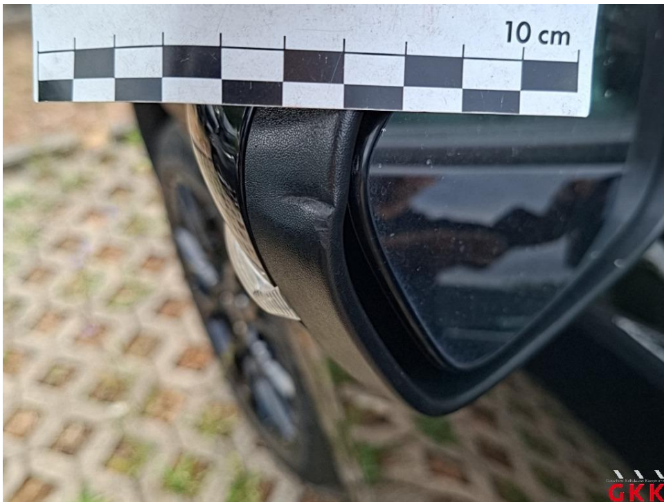
Bild 36. Spiegelgehäuse links, Rahmen, beschädigt, ersetzen
