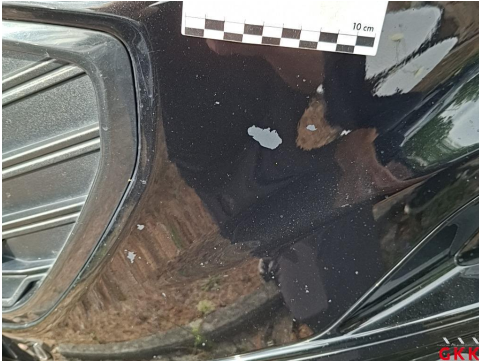
Bild 31. Stoßfänger vorne, Verkleidung -lackiert-, Steinschlag und Kratzer, lackieren
