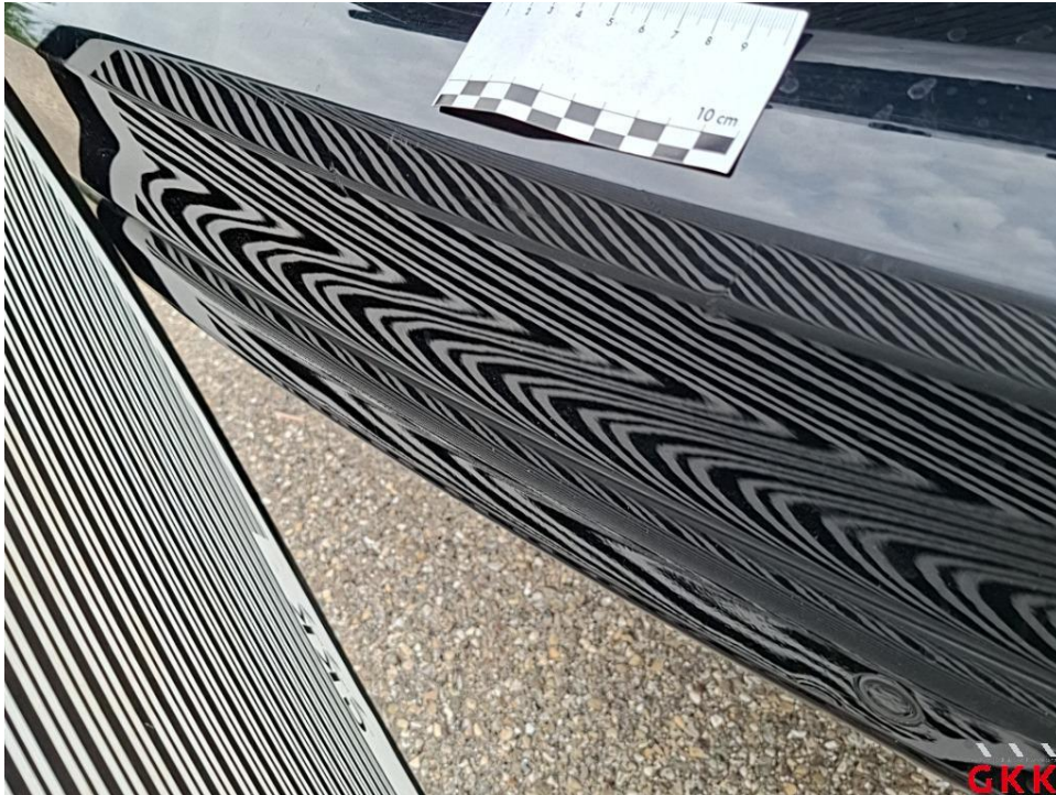
Bild 25. Stoßfänger hinten, Verkleidung oberhalb -lackiert-, beschädigt, ersetzen
