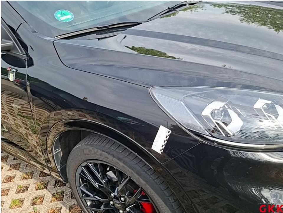
Bild 33. Kotflügel vorne rechts, verkratzt, Smartrepair
