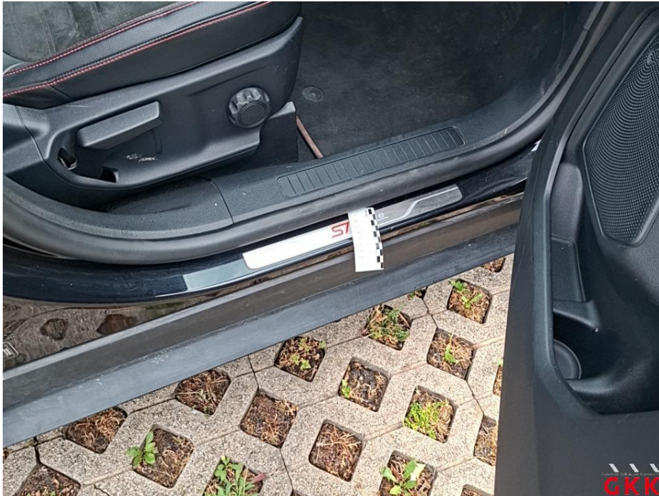
Bild 21. Tür vorne rechts, Einstieg, verkratzt, auslegen, schleifen, polieren
