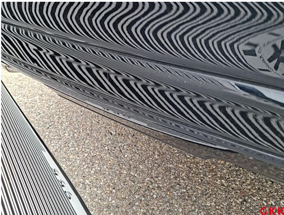
Bild 26. Stoßfänger hinten, Verkleidung oberhalb -lackiert-, beschädigt, ersetzen
