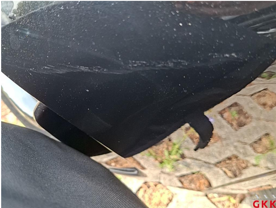
Bild 32. Stoßfänger vorne, Verkleidung -lackiert-, Steinschlag und Kratzer, lackieren
