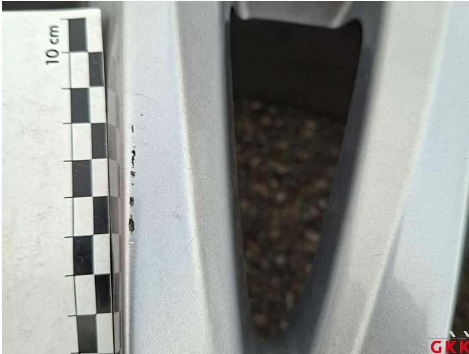
Bild 13. LM-Rad, 1 x beiliegend, verkratzt, Smartrepair
