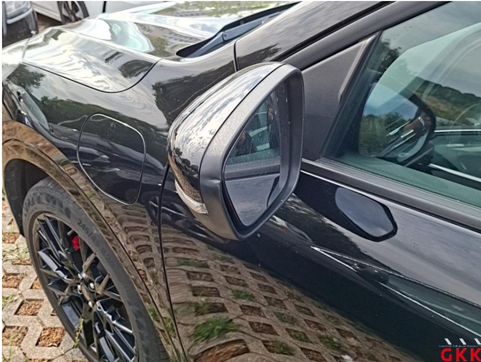
Bild 35. Spiegelgehäuse links, Rahmen, beschädigt, ersetzen
