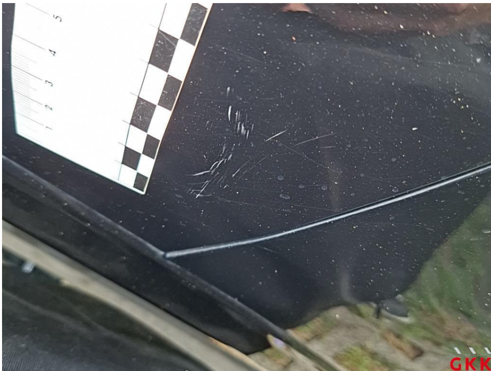
Bild 34. Kotflügel vorne rechts, verkratzt, Smartrepair
