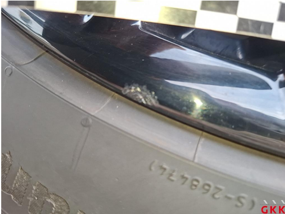
Bild 29. LM-Rad, hinten rechts, Materialabtrag, ersetzen
