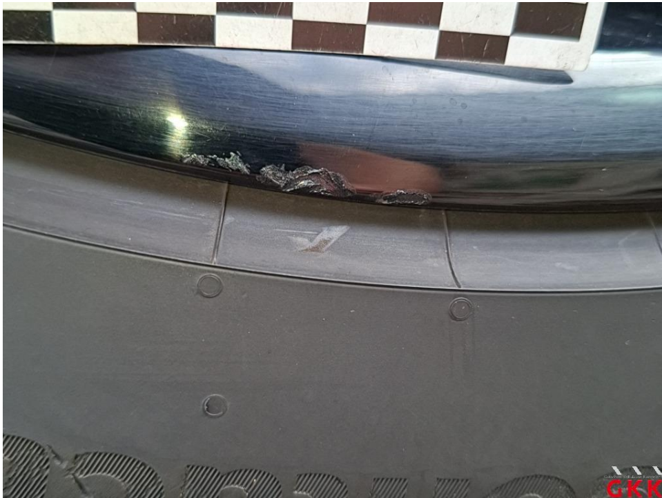
Bild 28. LM-Rad, hinten rechts, Materialabtrag, ersetzen
