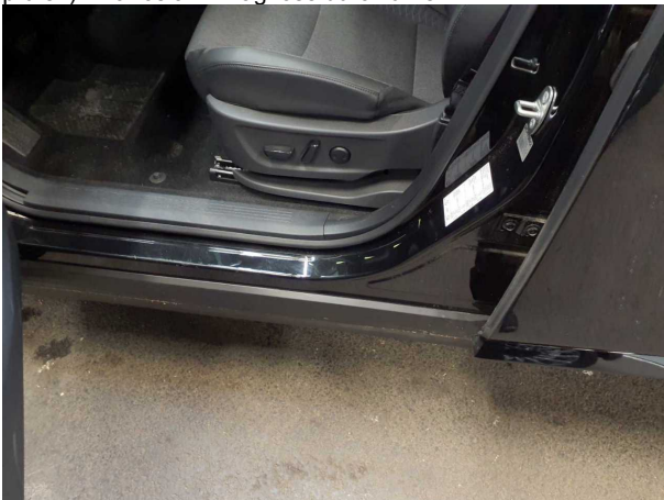
Beschädigung #2: Schweller links: Einstieg - verkratzt / verschürft - auslegen / polieren
