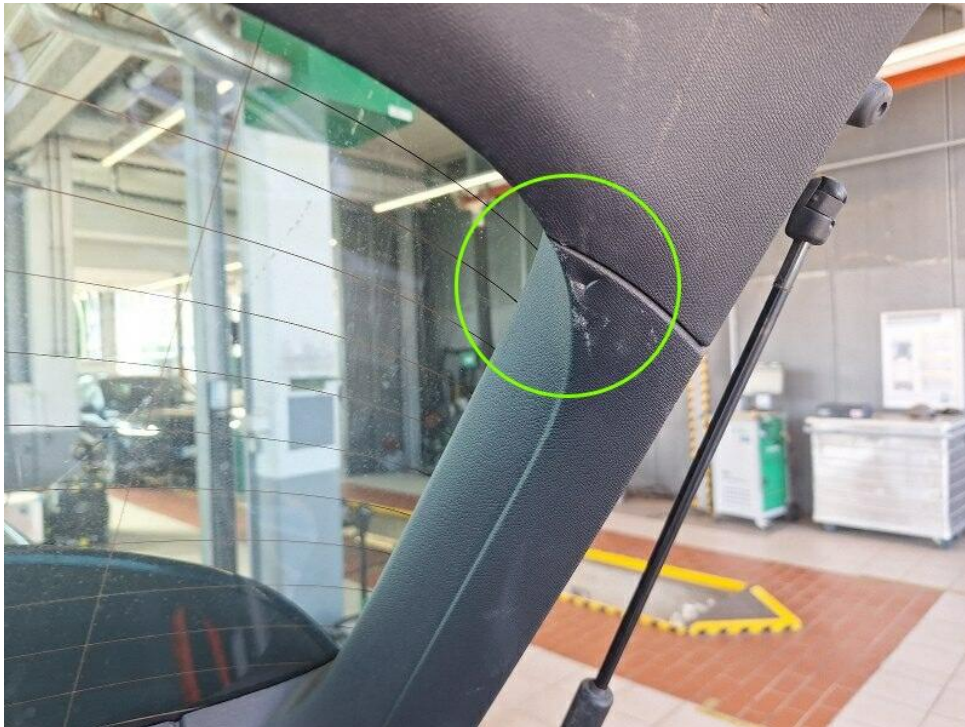
Bild 25 : Verkleidung Heckklappe rechts gebrochen
