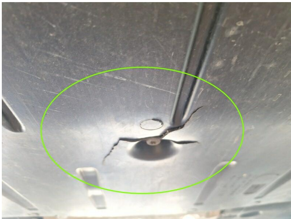
Bild 24 : Unterbodenverkleidung vorne gebrochen
