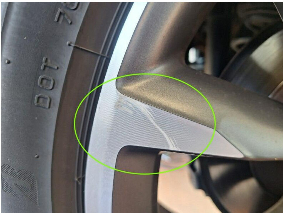
Bild 22 : Sommerfelge hinten rechts zerkratzt ( Glanzgedreht )
