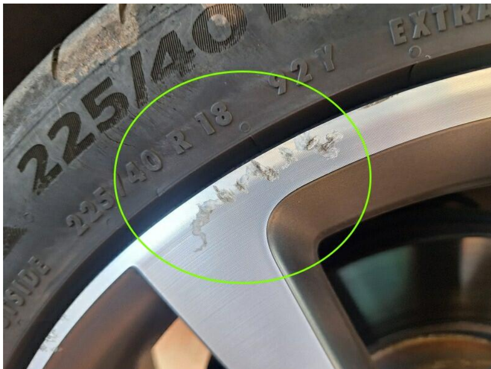
Bild 20 : Sommerfelge vorne rechts zerkratzt ( Glanzgedreht )
