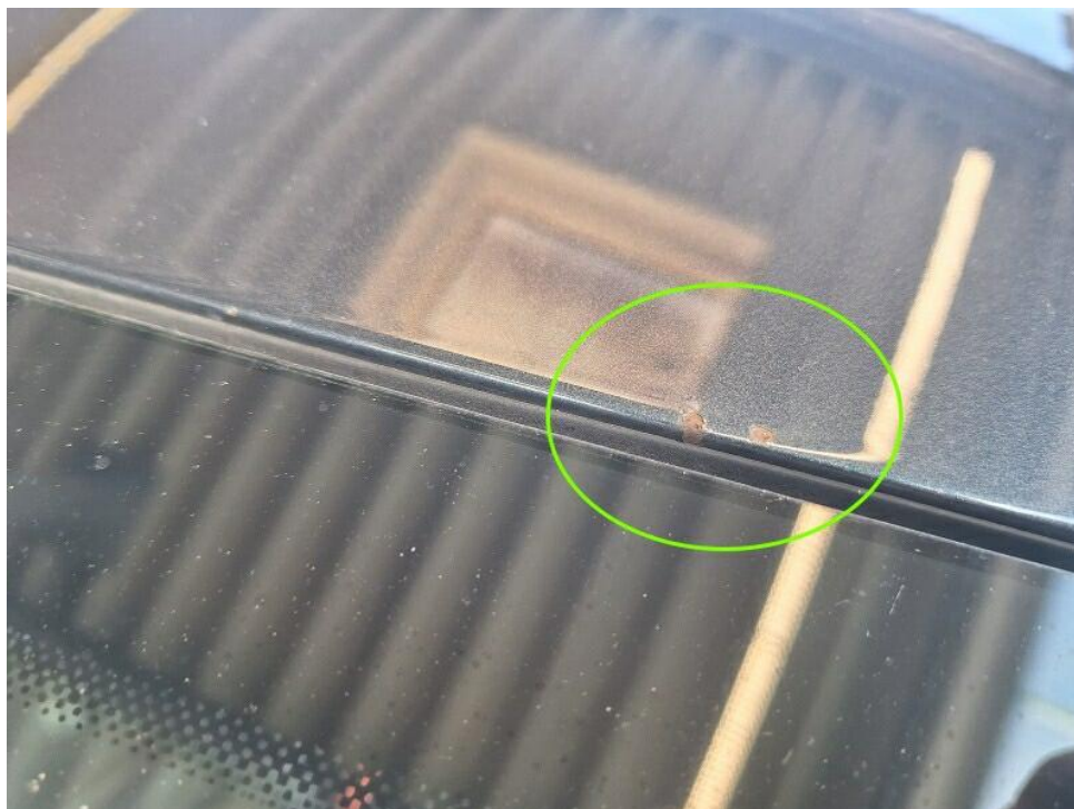
Bild 16 : Dachkante vorne Steinschlagabplatzungen mit Rostbildung
