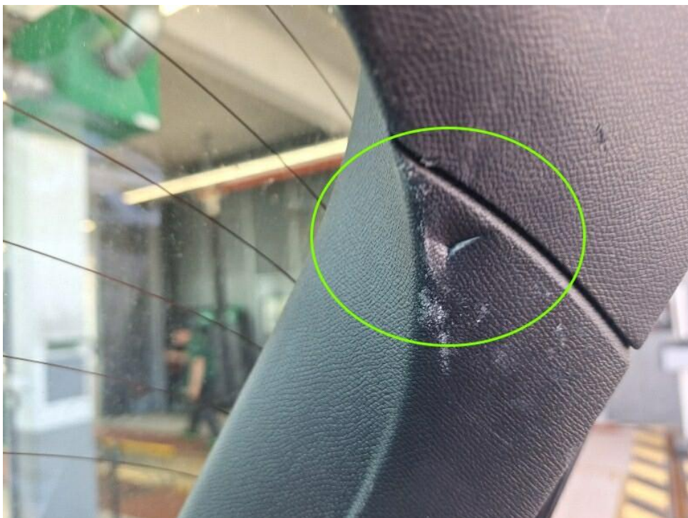
Bild 26 : Verkleidung Heckklappe rechts gebrochen
