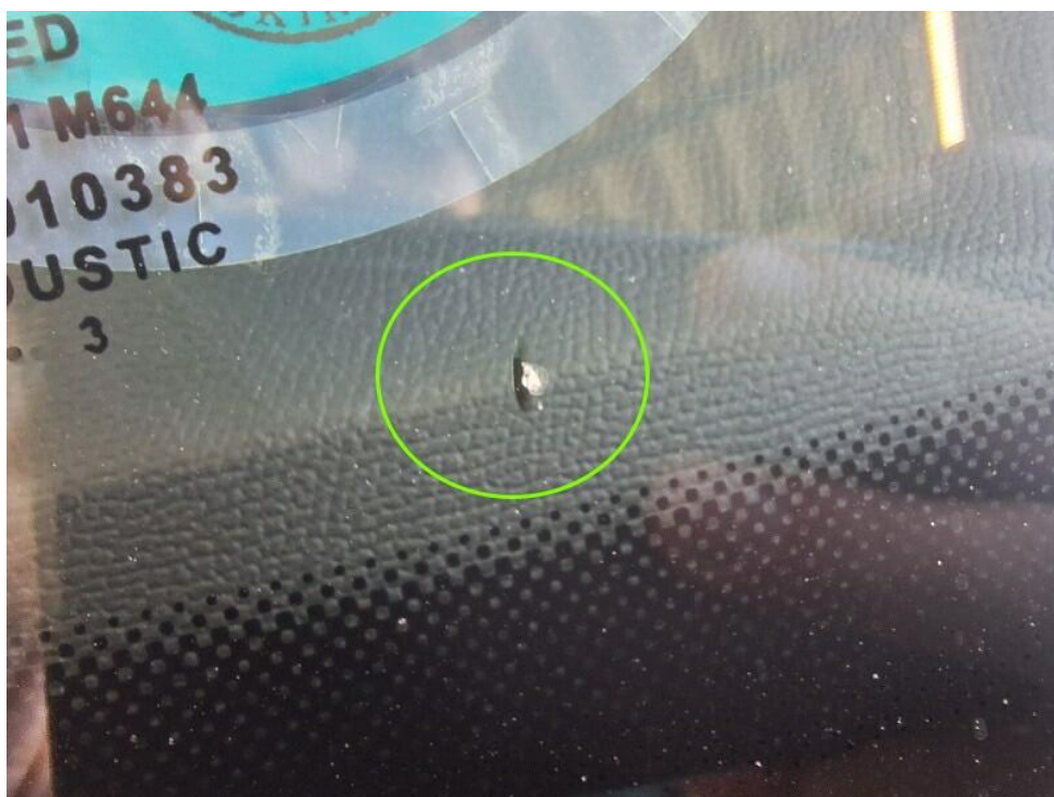
Bild 18 : Frontscheibe Steinschlag mit Rissbildung
