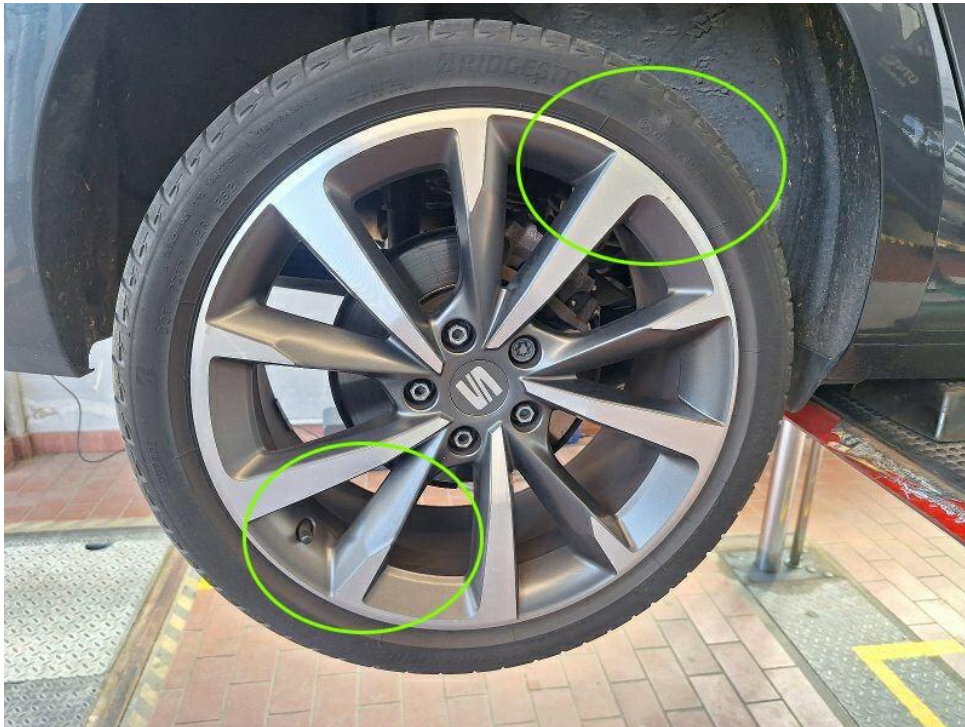
Bild 21 : Sommerfelge hinten rechts zerkratzt ( Glanzgedreht )
