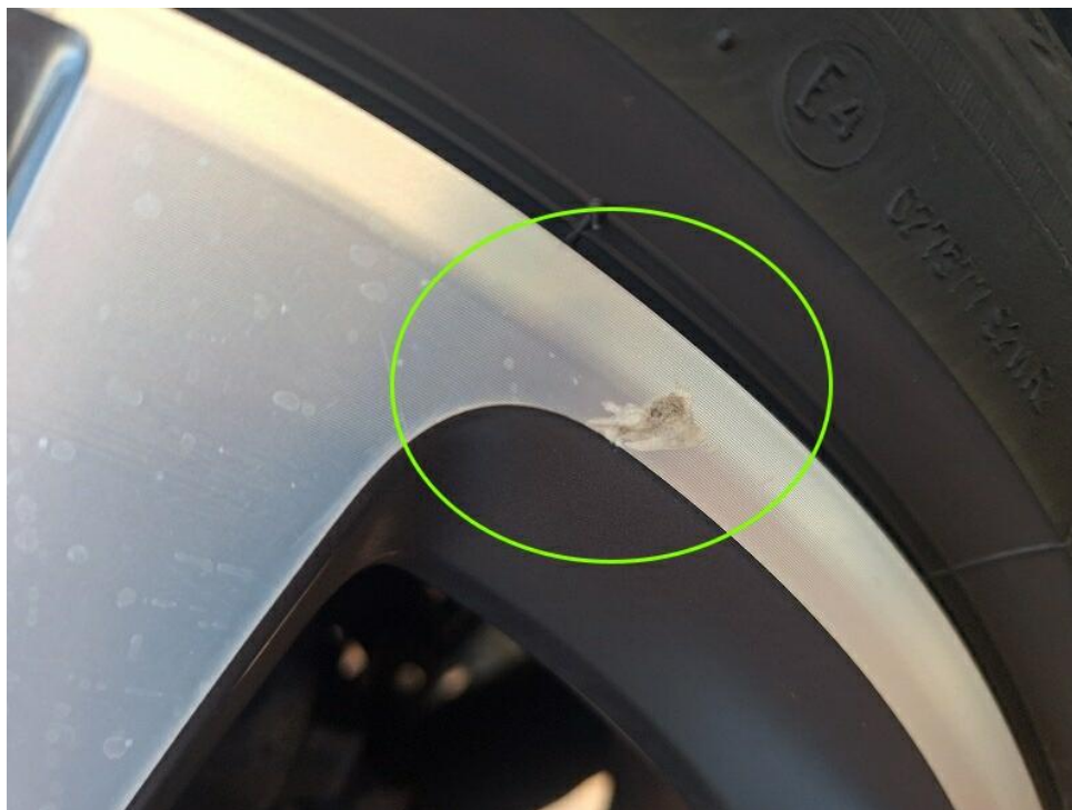
Bild 23 : Sommerfelge hinten rechts zerkratzt ( Glanzgedreht )
