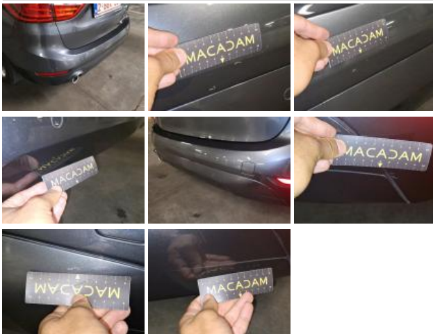
Door RR, Scratch(es), Acceptable
