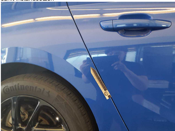
Beschädigung #5: Seitenwand rechts: Seitenwand (Unterhalb) - Kratzer - lackieren
