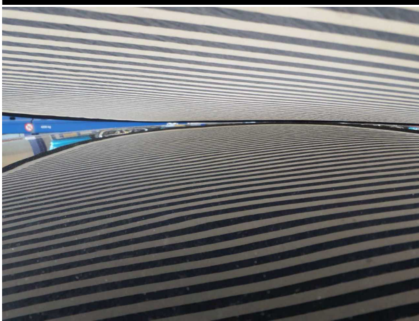
Beschädigung #6: Fahrzeugdach: Dach - nicht fachgerecht instandgesetzt - erneuern
