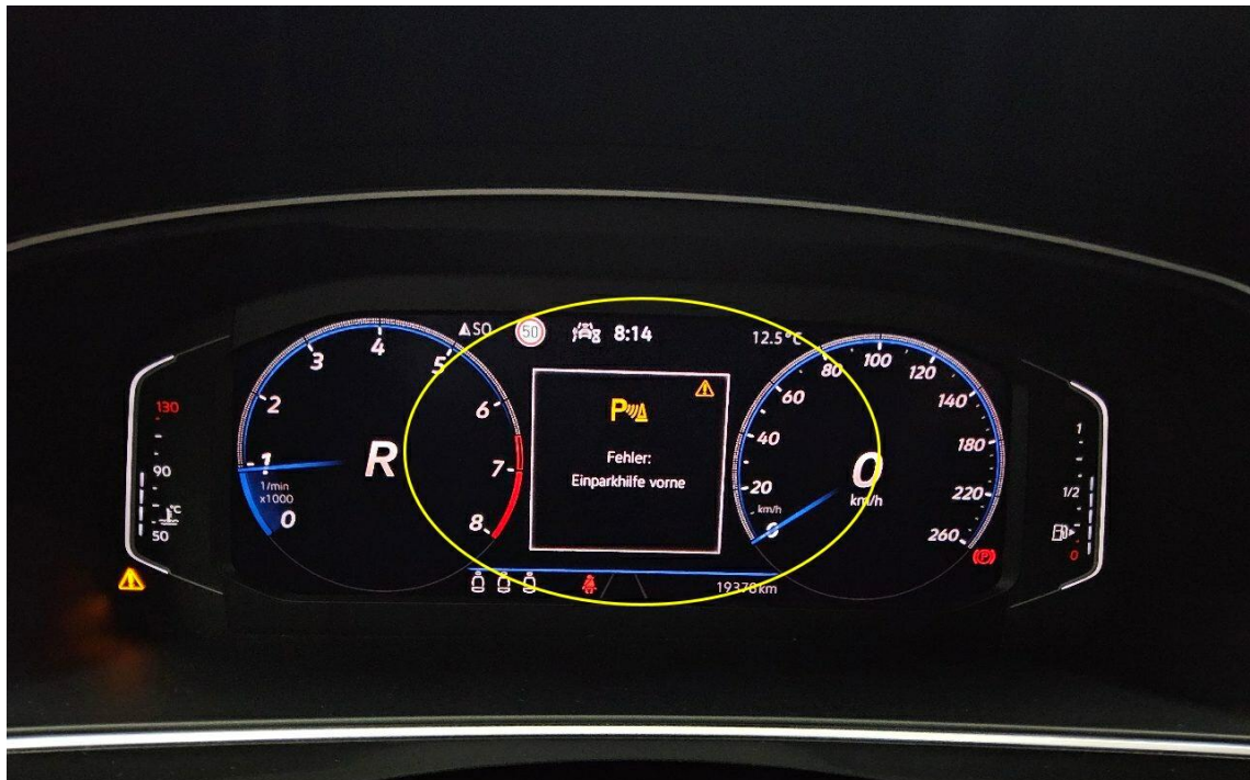
Bild 15 : Fehler Einparkhilfe vorne leuchtet
