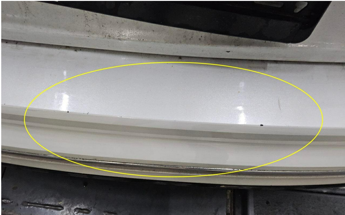
Bild 17 : Ladekante hinten verschrammt
