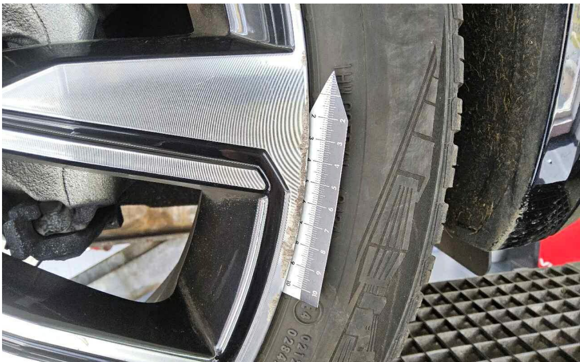
Bild 10 : Alufelge glanzgedreht vorne rechts, mehrfach verschrammt mit Materialabtrag
