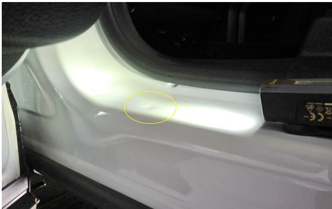
Bild 13 : Türeinstieg hinten links, Delle
