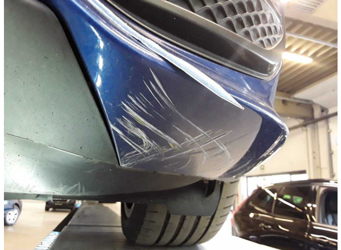
Wear and tear 3: Front bumper: Front bumper (außerhalb Sichtbereich) - Scratched - No deduction
