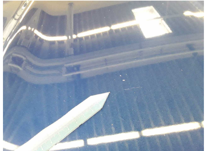
Damage 4: Bonnet: Bonnet (Vogelkot eingebrannt) - Paint defect - Paint
