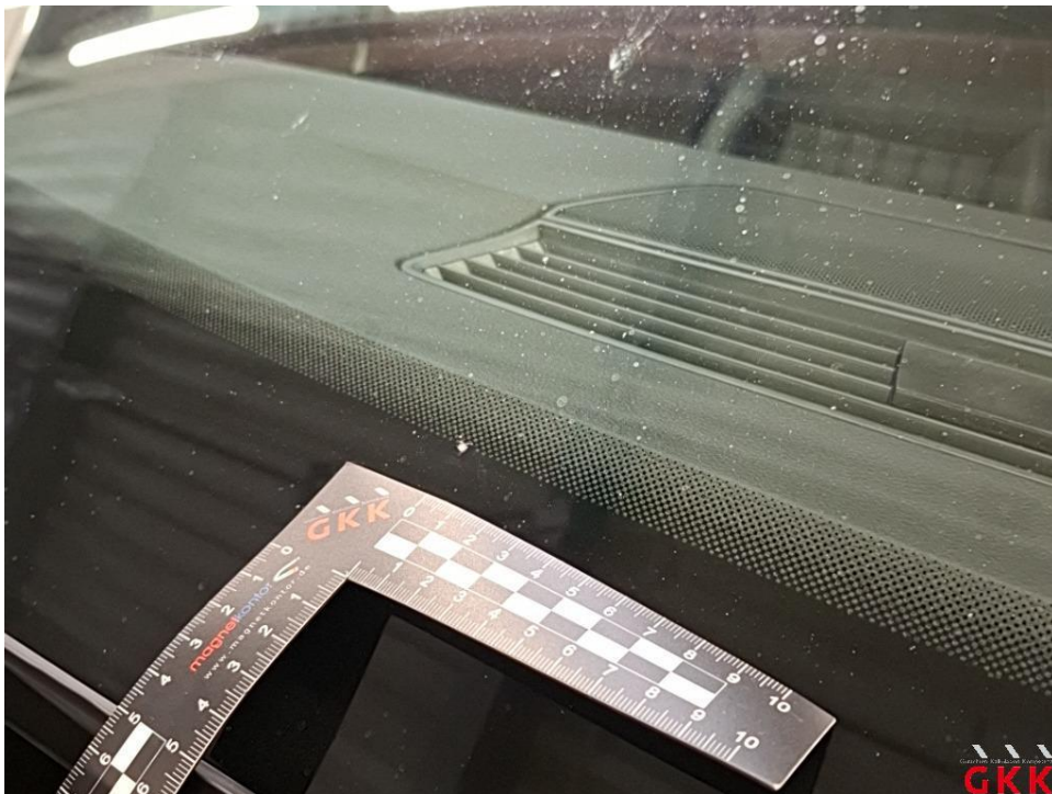
Bild 16 Frontscheibe, beschädigt, ersetzen
