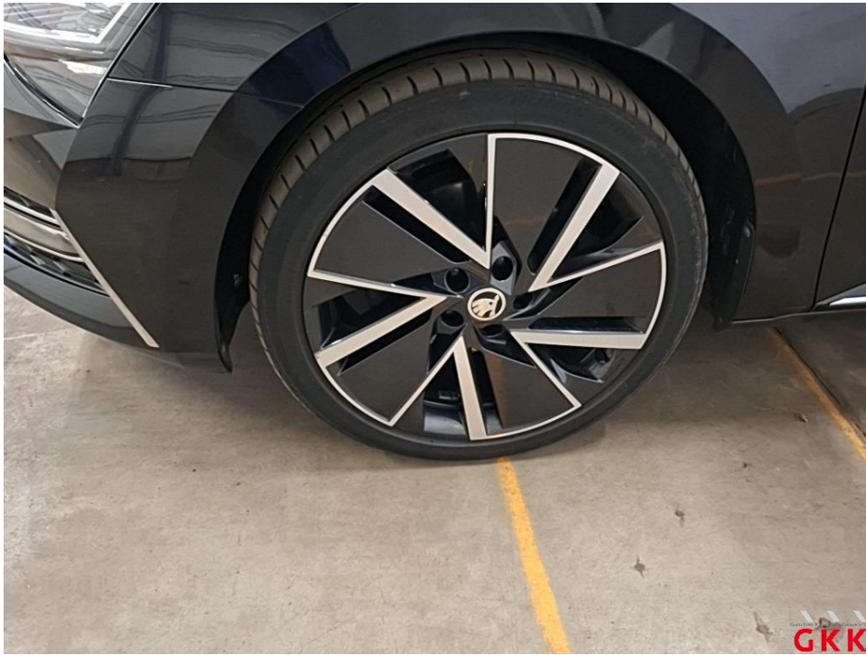
Bild 18 LM-Rad, vorne links, Materialabtrag, ersetzen
