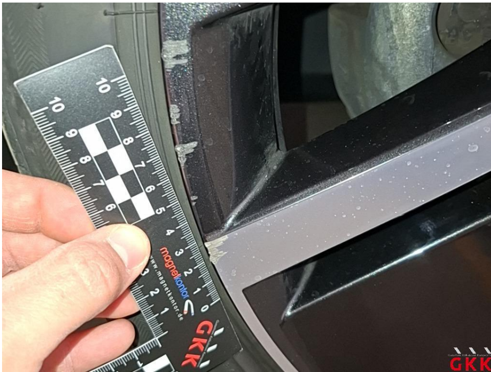
Bild 19 LM-Rad, vorne links, Materialabtrag, ersetzen
