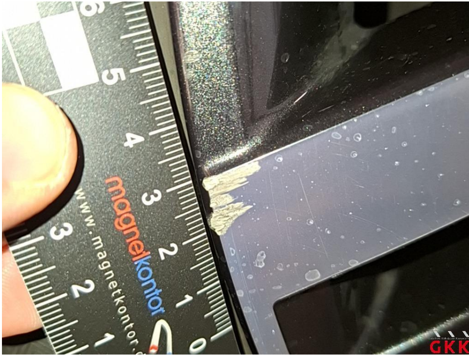
Bild 20 LM-Rad, vorne links, Materialabtrag, ersetzen
