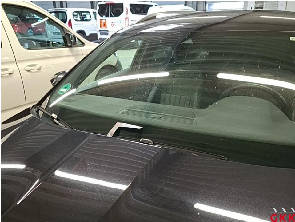
Bild 15 Frontscheibe, beschädigt, ersetzen
