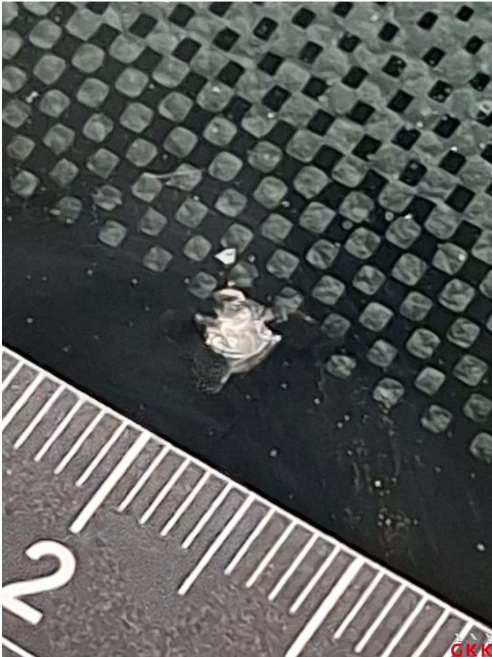
Bild 17 Frontscheibe, beschädigt, ersetzen
