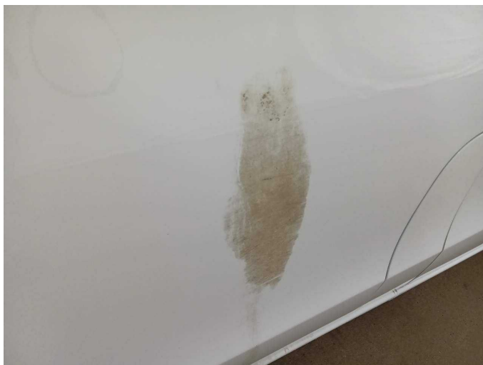
Damage 2: Door - front left side: Door (Mehrkosten möglich) - Paint defect - Conditioning
