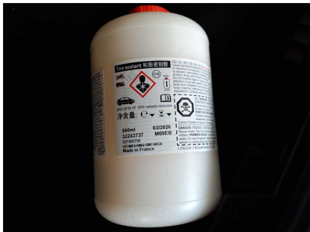
Beschädigung #1: Ausrüstung: Tirefit Füllmittel - abgelaufen - erneuern
