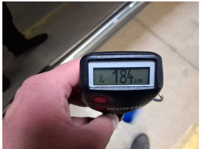
Door - front left side: 184 µm
