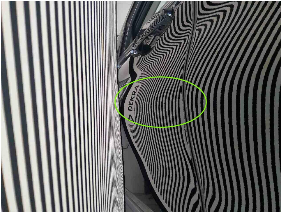
Bild 15 : Tür vorne links, eingedellt
