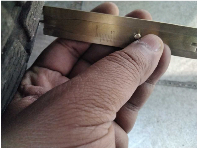
Wear and tear 6: Wheel / tyres: Tyre - front right side (Winterradsatz gehört nicht zur Ausstattung) - Does not meet the leasing specifications - No deduction
