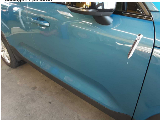
Beschädigung #2: Tür vorn rechts: Tür (Baumharz) - Lackmangel - auslegen / polieren
