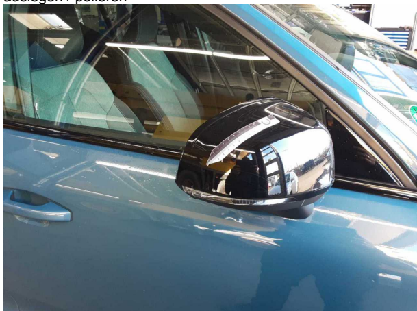
Beschädigung #3: Außenspiegel rechts: Abdeckkappe - verkratzt / verschürft - Smart Repair
