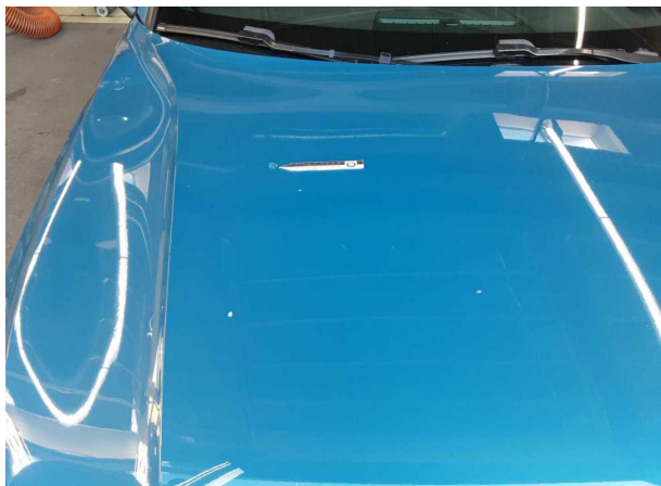
Beschädigung #1: Motorhaube: Motorhaube (Baumharz) - Lackman... - auslegen / polieren
