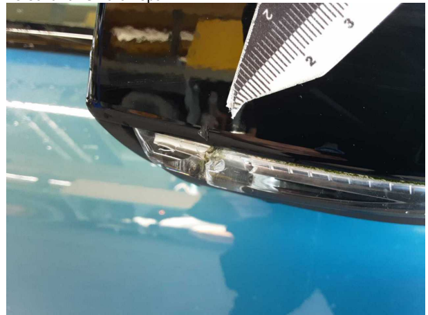
Beschädigung #5: Blinkleuchte: Spiegel rechts - gebrochen / gerissen - erneuern
