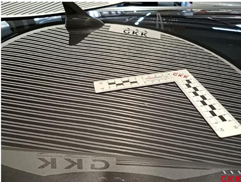
Bild 20 Dach, beschädigt, Smartrepair
