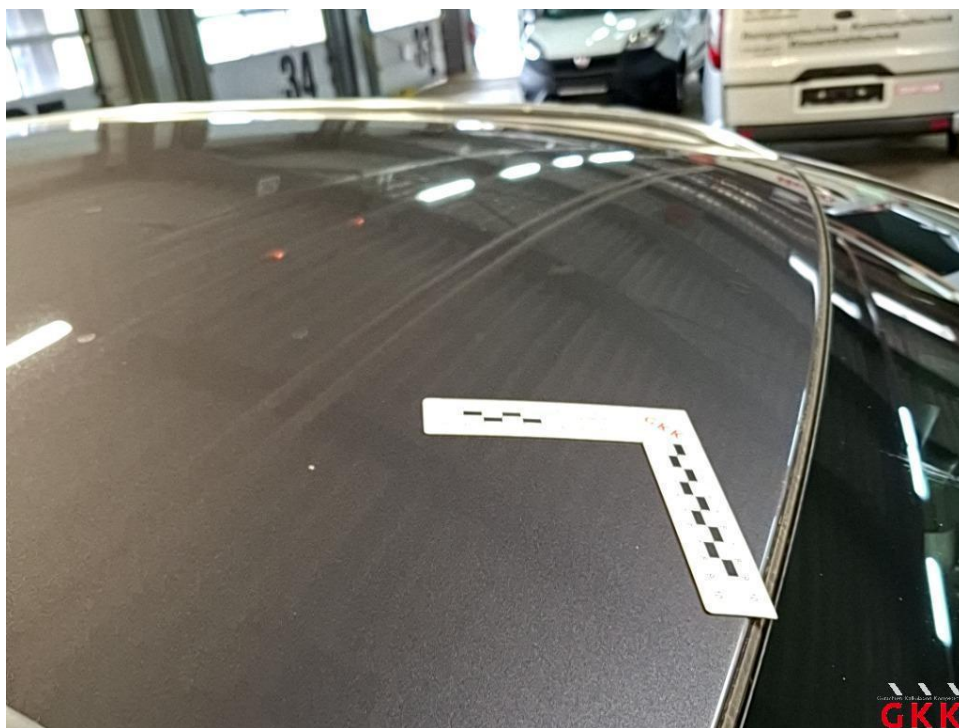
Bild 18 Dach, beschädigt, Smartrepair
