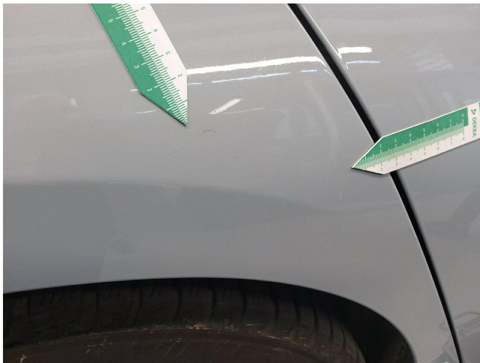
Bild 21 : Seitenwand hinten rechts diverse Kratzer
