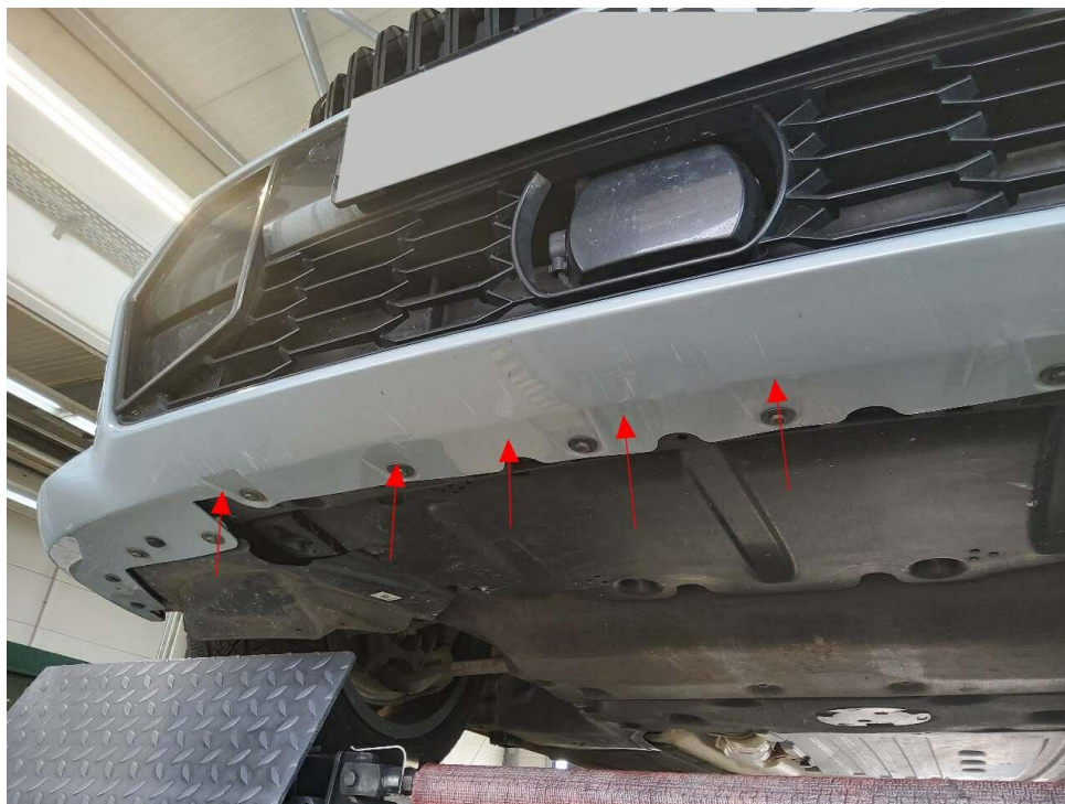
Bild 18 : Stoßfänger vorne unten verschrammt
