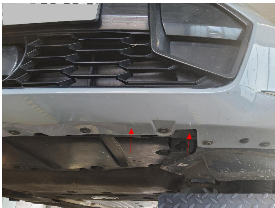
Bild 19 : Stoßfänger vorne unten verschrammt
