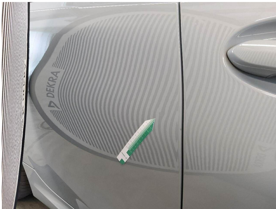
Bild 24 : Tür hinten rechts Delle
