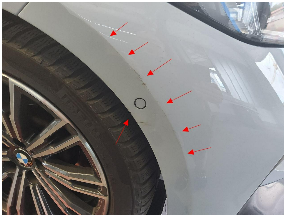
Bild 20 : Stoßfänger vorne verschrammt
