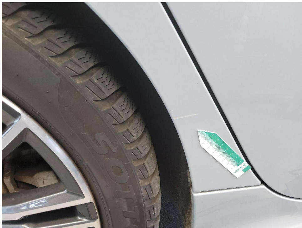
Bild 22 : Seitenwand hinten rechts diverse Kratzer
