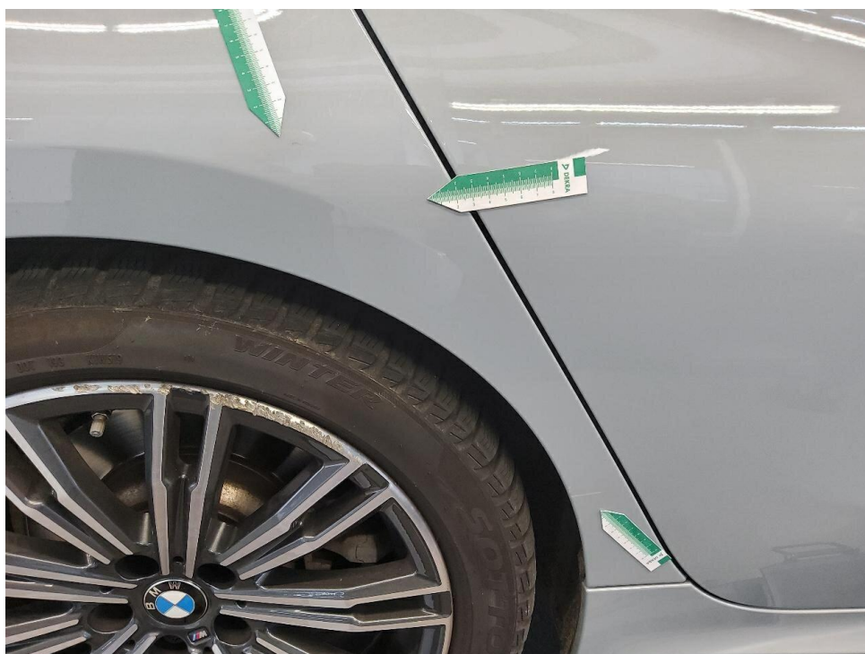
Bild 23 : Seitenwand hinten rechts diverse Kratzer
