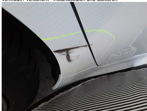
Beschädigung #15: Seitenwand rechts: Seitenwand - Delle / Lackschaden - instandsetzen und lackieren
