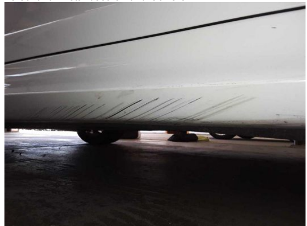
Beschädigung #11: Schweller rechts: Verkleidung - verkratzt / verschürft - instandsetzen und lackieren
