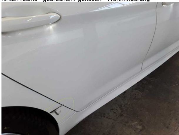
Beschädigung #8: Tür hinten rechts: Tür - verkratzt / verschürft - Smart Repair
