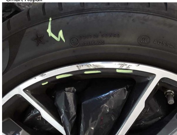
Beschädigung #9: 2.Radsatz: 2 Leichtmetallfelgen - verkratzt... verschürft - Wertminderung
