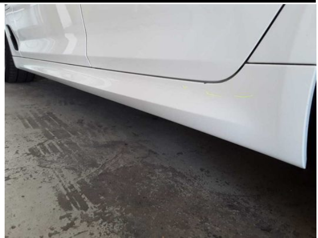
Beschädigung #10: Schweller links: Verkleidung - verkratzt / verschürft - instandsetzen und lackieren
