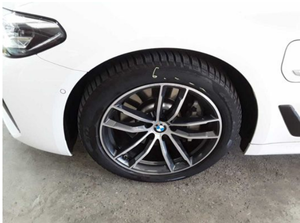
Beschädigung #1: Rad/Reifen: Leichtmetallfelge vorn links - verkratzt / verschürft - kein Abzug
