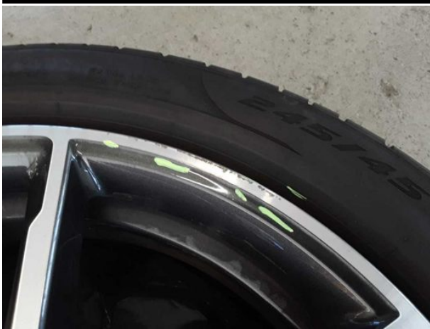
Beschädigung #9: 2.Radsatz: 2 Leichtmetallfelgen - verkratzt / verschürft - Wertminderung
