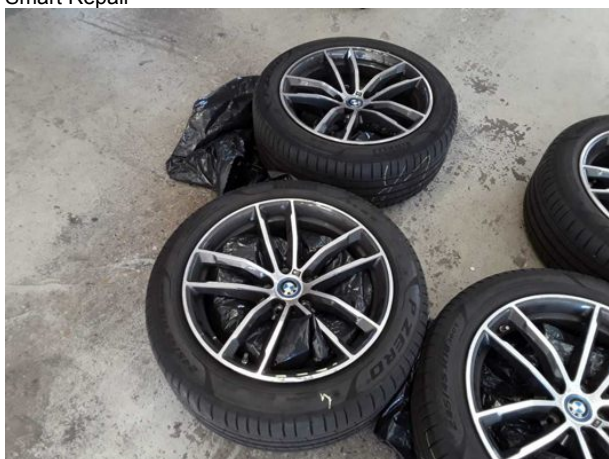
Beschädigung #9: 2.Radsatz: 2 Leichtmetallfelgen - verkratzt / verschürft - Wertminderung
