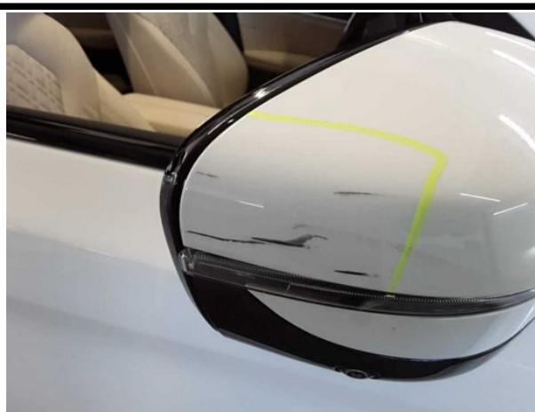
Beschädigung #7: Außenspiegel rechts: Abdeckkappe - verkratzt / verschürft - Smart Repair
