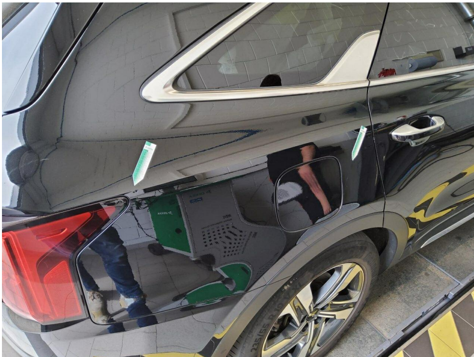
Bild 18 : Seitenteil hinten rechts, deformiert, instandsetzen und lackieren mit Lackaufbau
