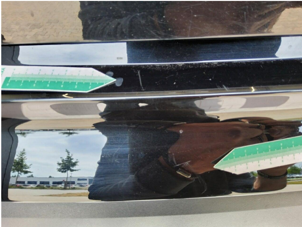
Bild 25 : Stoßfänger hinten Lackierung, zerkratzt, lackieren
