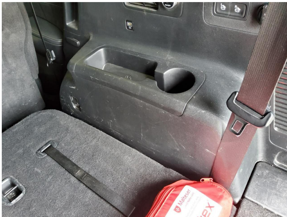
Bild 28 : Kofferraumverkleidungen verschrammt, Minderwert
