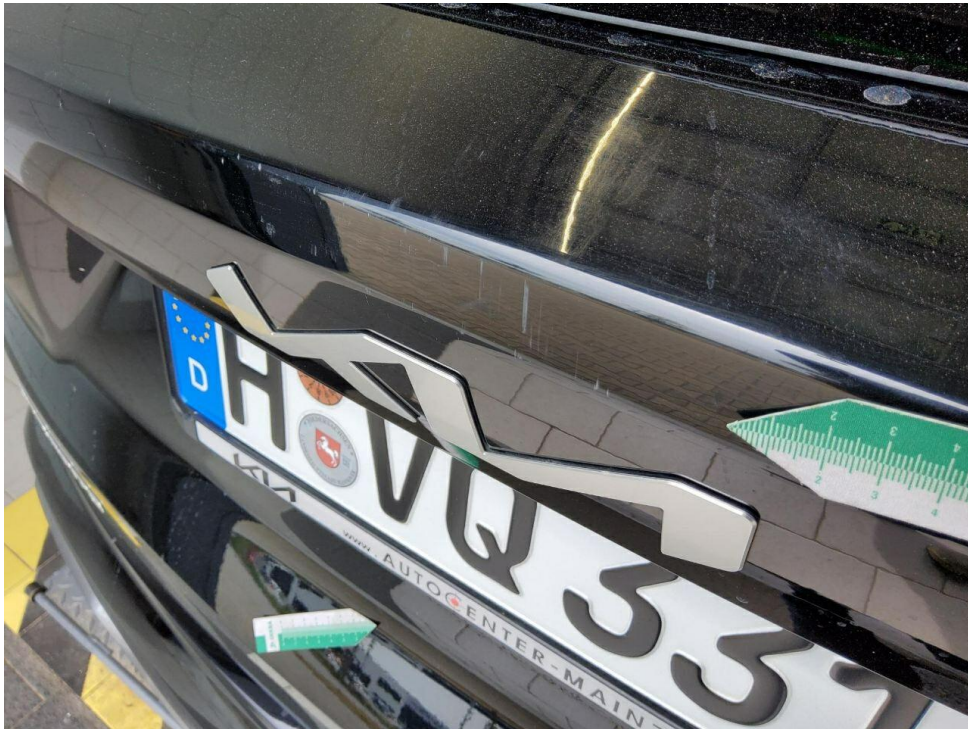
Bild 17 : Heckklappe Lackierung, verschrammt, lackieren
