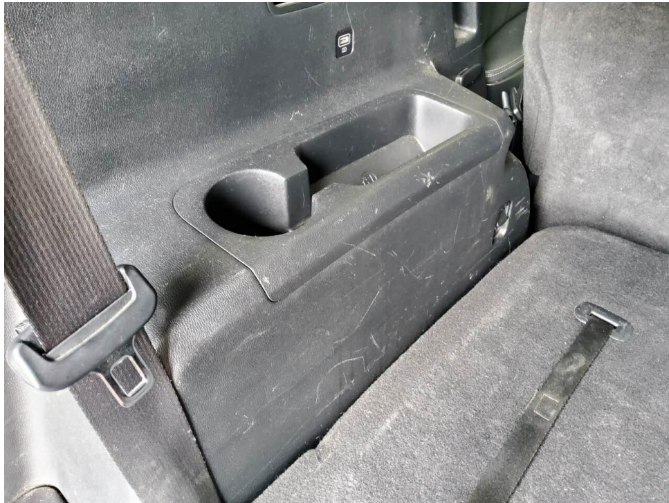
Bild 27 : Kofferraumverkleidungen verschrammt, Minderwert
