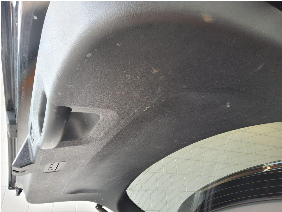
Bild 31 : Kofferraumverkleidungen verschrammt, Minderwert
