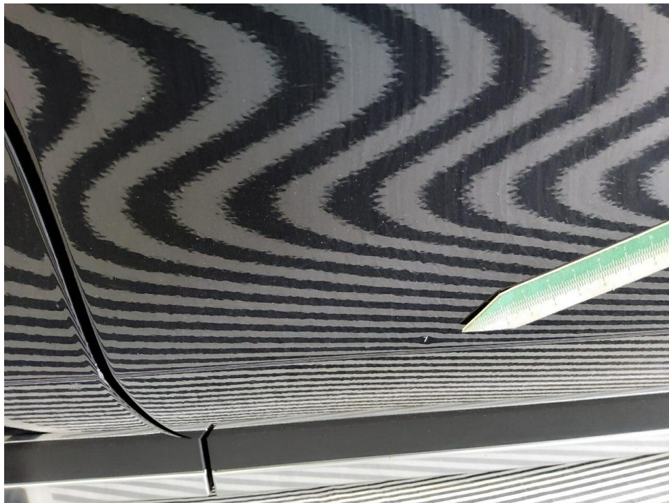
Bild 12 : Tür hinten links Lackierung, verschrammt, lackieren mit Lackaufbau
