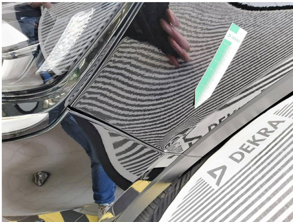
Bild 10 : Kotflügel vorne links, deformiert, instandsetzen und lackieren mit Lackaufbau
