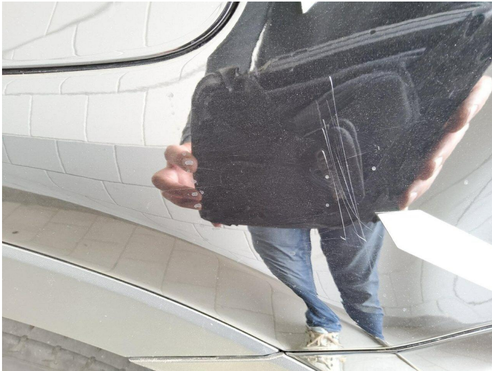
Bild 15 : Seitenteil hinten links Lackierung, zerkratzt, lackieren
