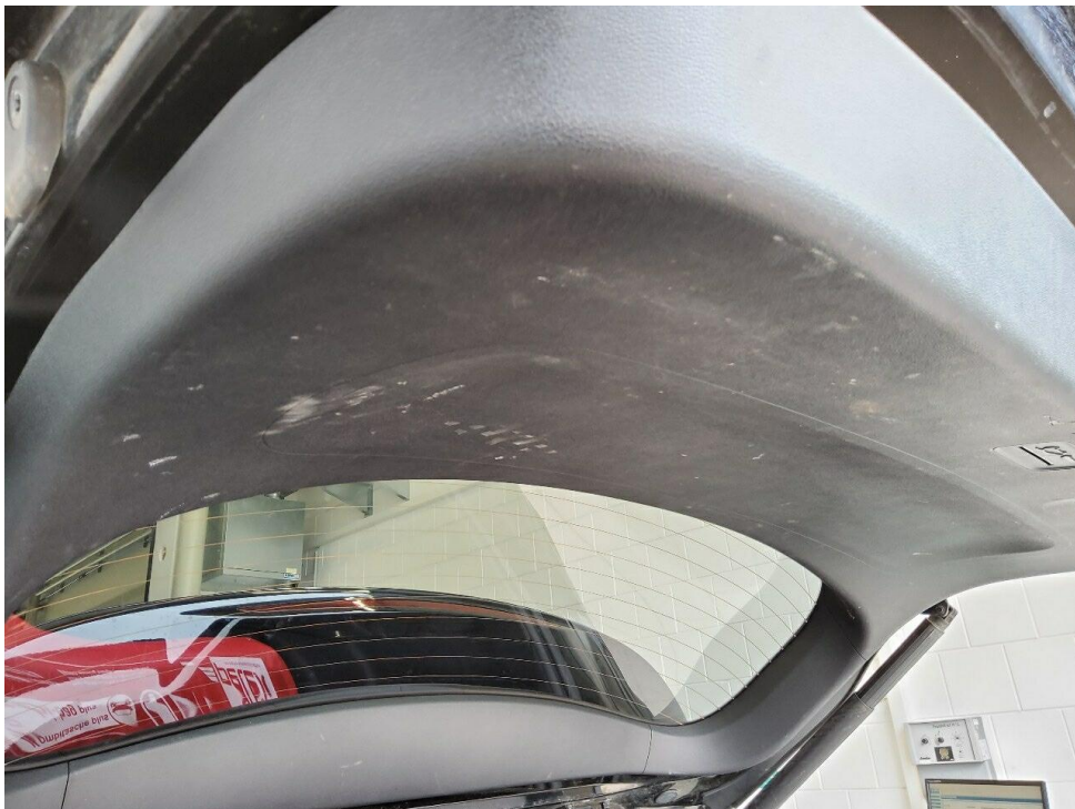
Bild 32 : Kofferraumverkleidungen verschrammt, Minderwert
