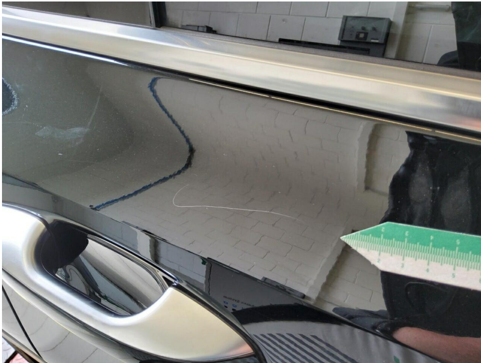
Bild 21 : Tür hinten rechts Lackierung, fleckig, lackieren
