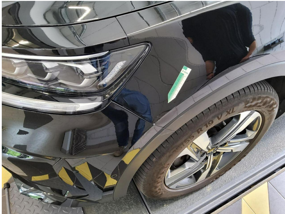
Bild 9 : Kotflügel vorne links, deformiert, instandsetzen und lackieren mit Lackaufbau
