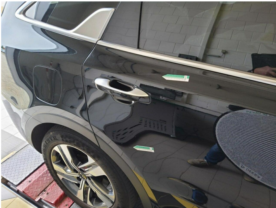
Bild 20 : Tür hinten rechts Lackierung, fleckig, lackieren
