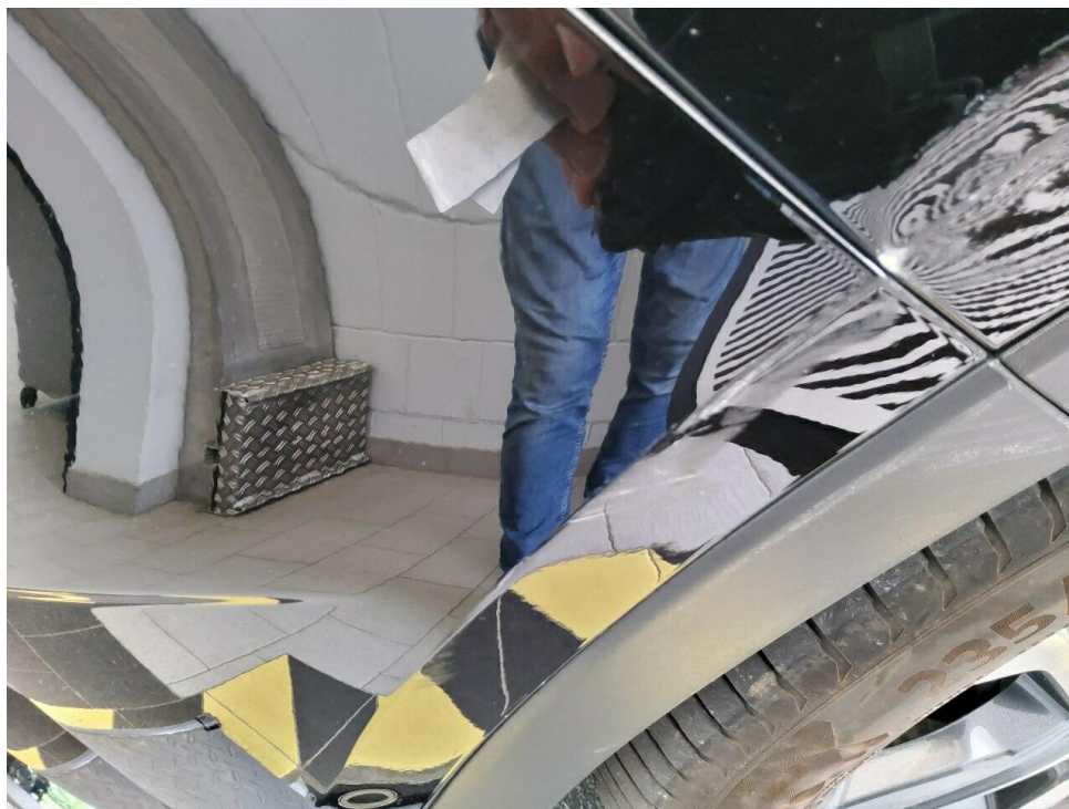
Bild 34 : Stoßfänger vorne links deformiert und gebrochen im Halterbereich
