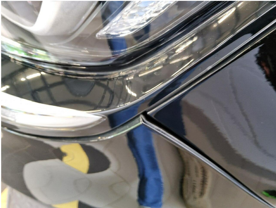
Bild 35 : Stoßfänger vorne links deformiert und gebrochen im Halterbereich
