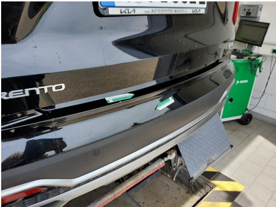
Bild 24 : Stoßfänger hinten Lackierung, zerkratzt, lackieren
