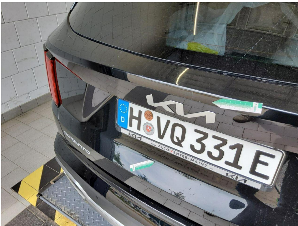
Bild 16 : Heckklappe Lackierung, verschrammt, lackieren
