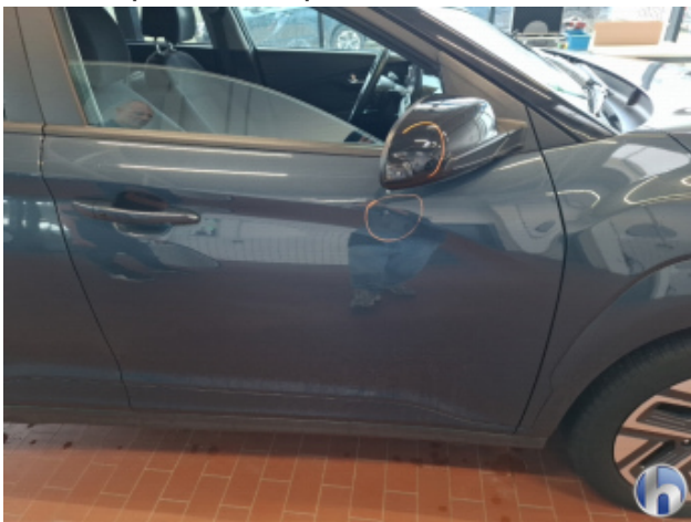
10. Tür Vorne - Rechts Delle Bis 40 Mm Mit Lackschaden - Smart Repair
