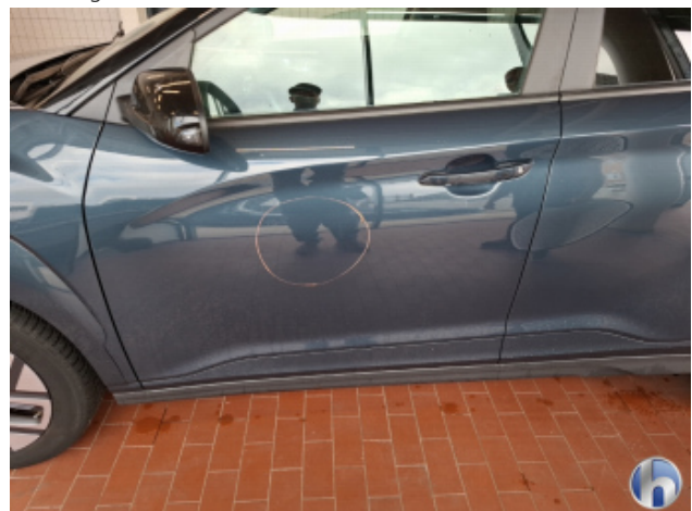
1. Tür Vorne - Links 2 Dellen - Sanft Instandsetzen
