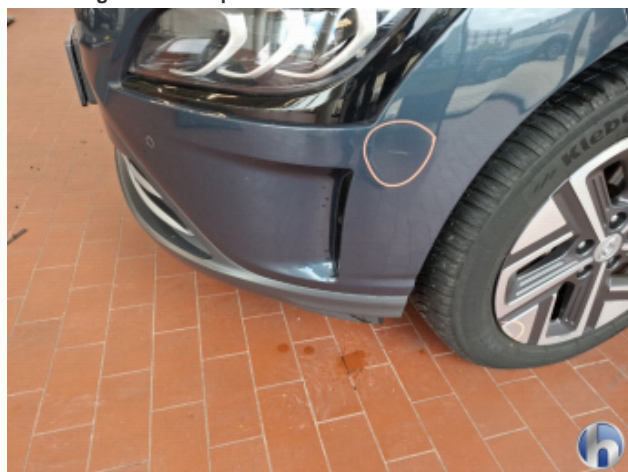
3. Stoßfänger Vorne Abschürfung - Smart Repair
