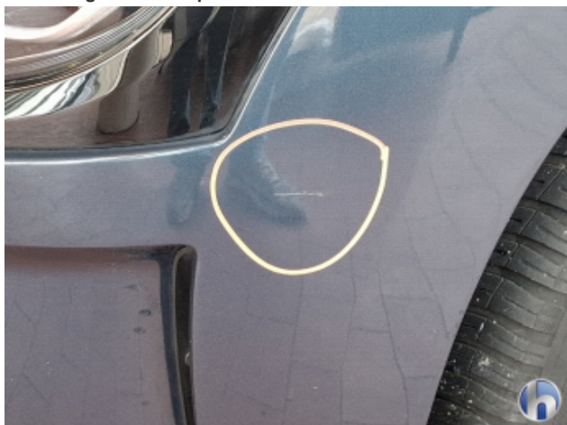
3. Stoßfänger Vorne Abschürfung - Smart Repair
