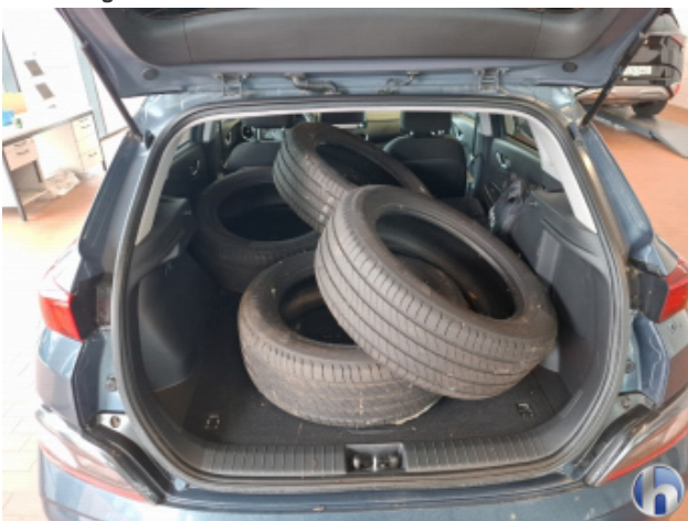
13. Hutablage Fehlt - Erneuern
