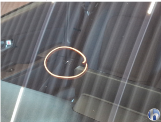
12. Windschutzscheibe Beschädigt - Erneuern
