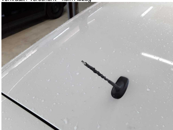
Beschädigung #2: Fahrzeugdach: Antennenstab - Marderschaden - erneuern
