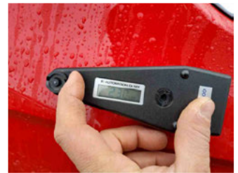
Lackstärke Seitenwand hinten rechts
