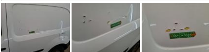
Panneau ARG, Bosse(s) et griffe(s), LI - Réparer et peindre (complet)
