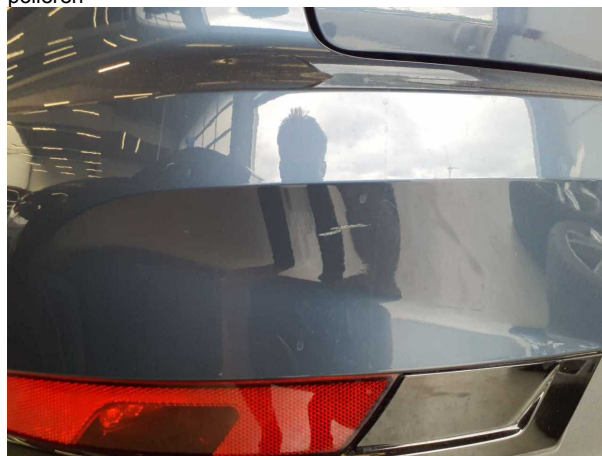
Beschädigung #4: Stossfänger hinten: Stossfänger hinten - Kratzer - lackieren
