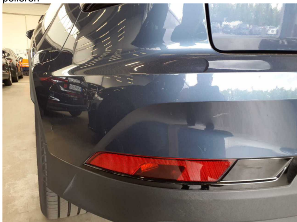
Beschädigung #4: Stossfänger hinten: Stossfänger hinten - Kratzer - lackieren
