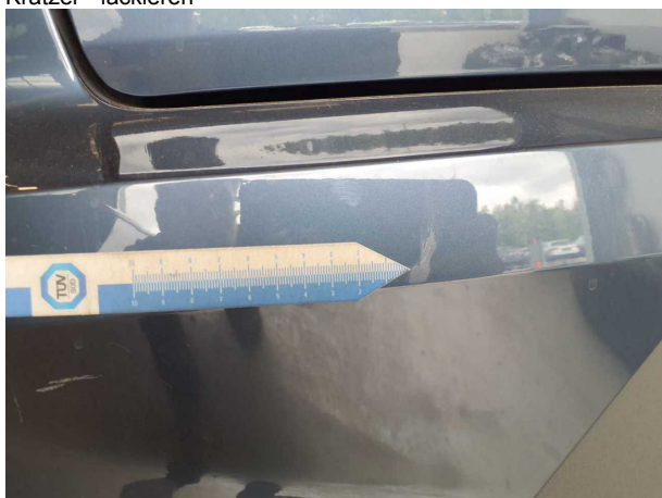
Beschädigung #4: Stossfänger hinten: Stossfänger hinten - Kratzer - lackieren
