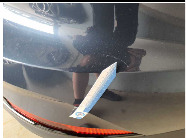
Beschädigung #4: Stossfänger hinten: Stossfänger hinten - Kratzer - lackieren
