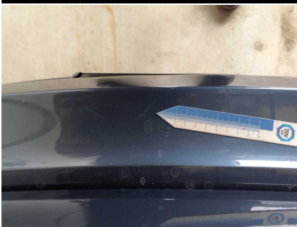
Beschädigung #4: Stossfänger hinten: Stossfänger hinten - Kratzer - lackieren
