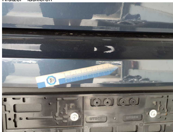
Beschädigung #4: Stossfänger hinten: Stossfänger hinten - Kratzer - lackieren
