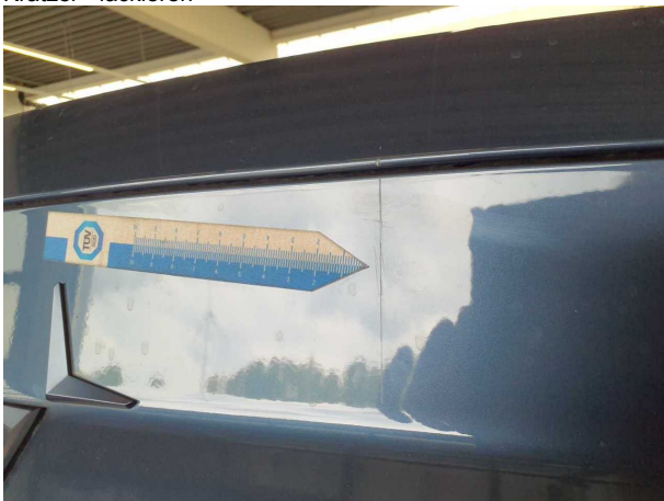
Beschädigung #5: Heckklappe/-tür: Heckklappe - Delle / Lackschaden - instandsetzen und lackieren
