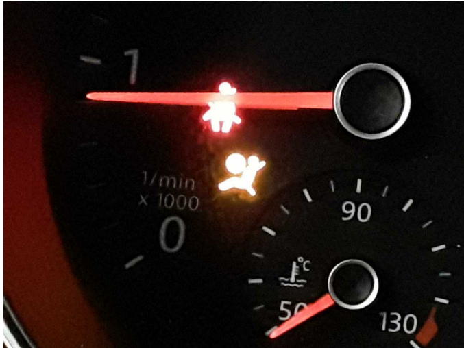
Damage 3: Instrument panel: Indicator light (Airbag, Zusatzkosten können entstehen) - on - Perform diagnosis
