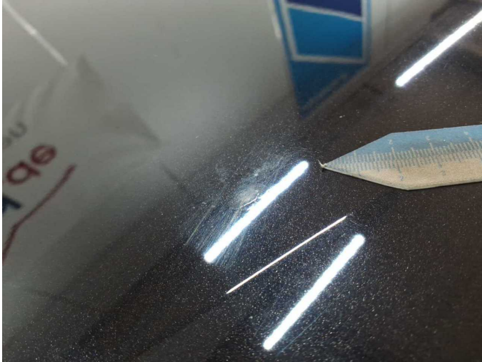
Damage 10: Bonnet: Bonnet (Verätzungen) - Paint defect - Paint
