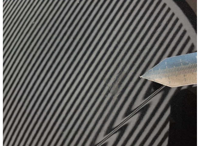
Damage 10: Bonnet: Bonnet (Verätzungen) - Paint defect - Paint
