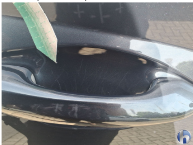
2. Tür Hinten - Rechts Gebrauchsspuren - Ohne Reparatur
