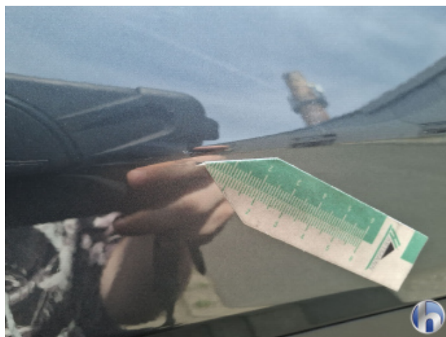
7. Seitenwand - Hinten - Links Kratzer - Smart Repair
