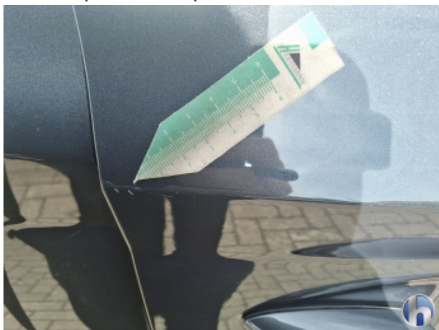
4. Tür Vorne - Rechts Steinschlag - Smart Repair
